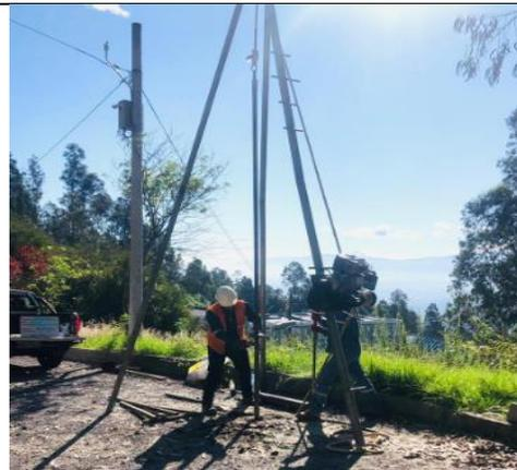
**Foto 2.-** Extracción de Muestras Sondeo 1-
