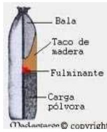
Se modificó la colocación del pistón, Este diseño dio origen al cartucho conocido como Chassepot, el cual marcó un importante avance en la evolución de las municiones.
