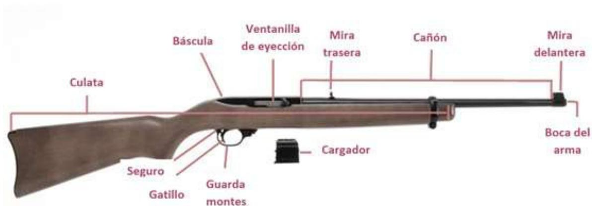
Figura 3.1.3.1. Constitución Arma Larga. Fuente: Tabla de Referencia de Armas de Fuego (RCMP-GRC / Interpol)
