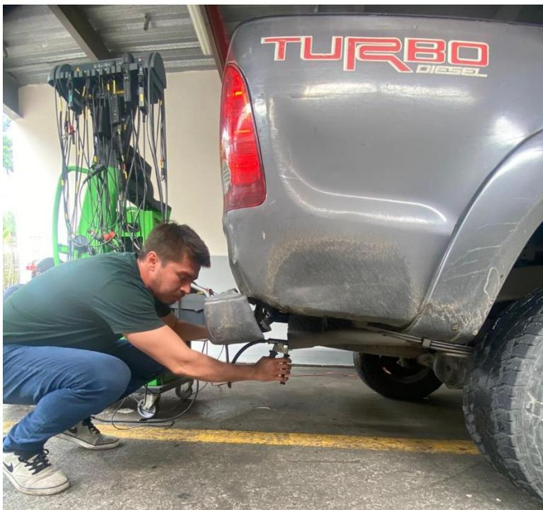
Asegurar de seguir las instrucciones del fabricante para conectar correctamente el equipo y asegurar un sellado adecuado alrededor del escape.
