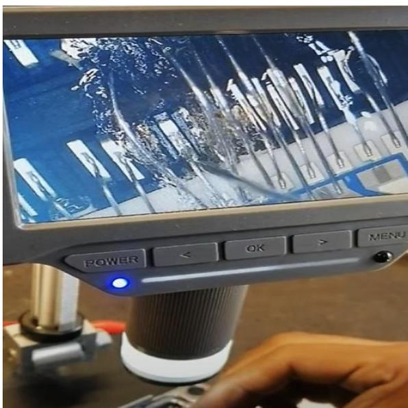
Esta herramienta permitió una revisión más precisa, facilitando la detección de daños imperceptibles a simple vista, como fisuras en las pistas o falsos contactos en componentes miniatura, asegurando una reparación exhaustiva y efectiva, ver figura 21.
