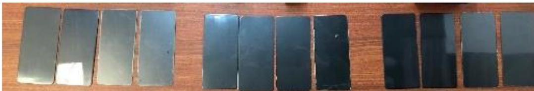
*Nota. Las probetas se encuentran ordenadas de izquierda a derecha en orden de gama básica, media y alta, donde el proceso de repintado se aplicó a dos de las probetas de cada grupo.*
