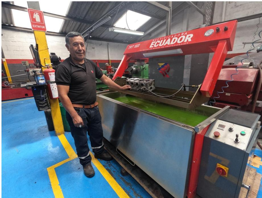
Imagen 12: Maquina de pruebas hidrostáticas sumergible.
