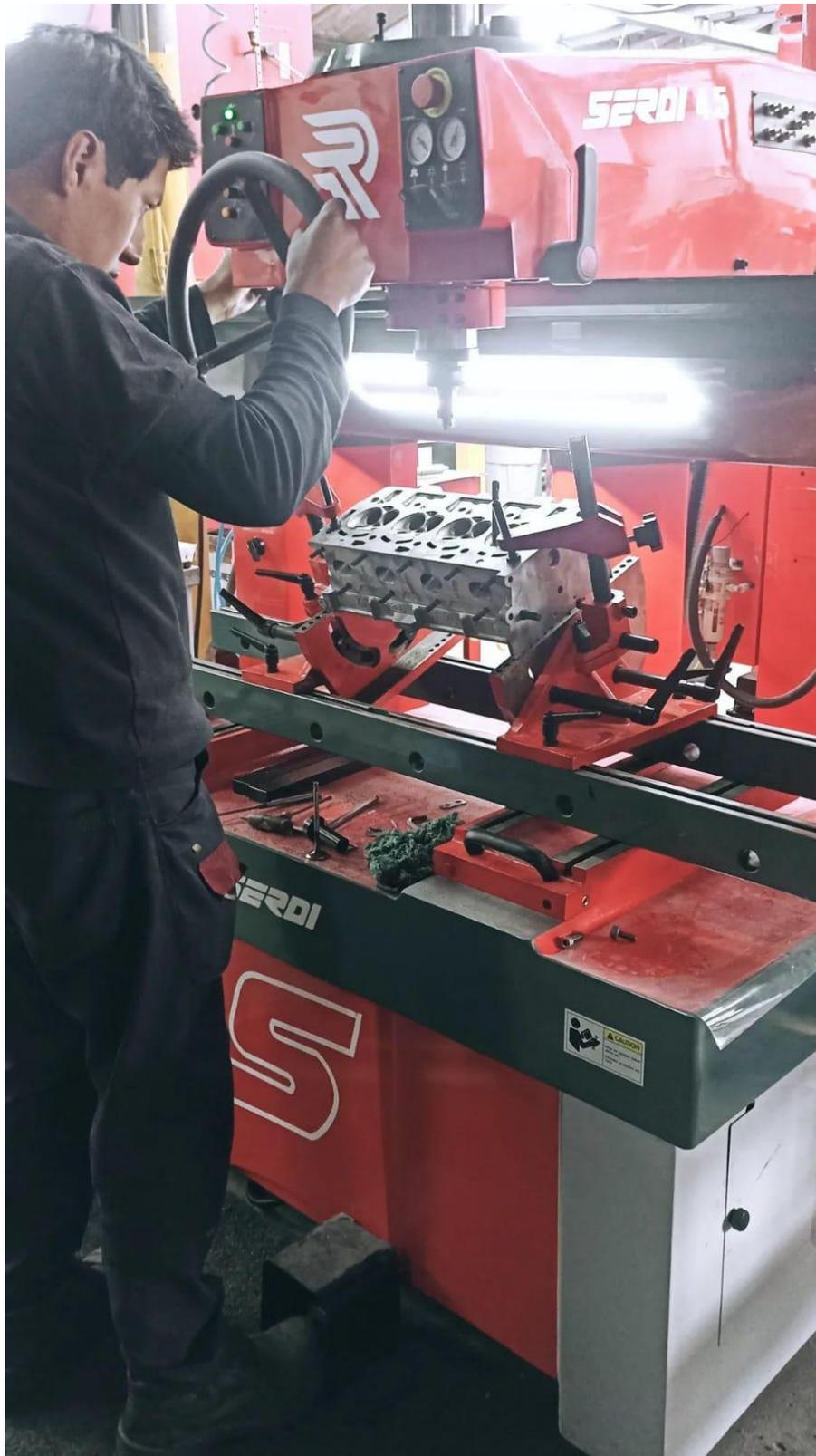
Imagen 13: Maquina de rectificar asientos de válvula en cabezotes
