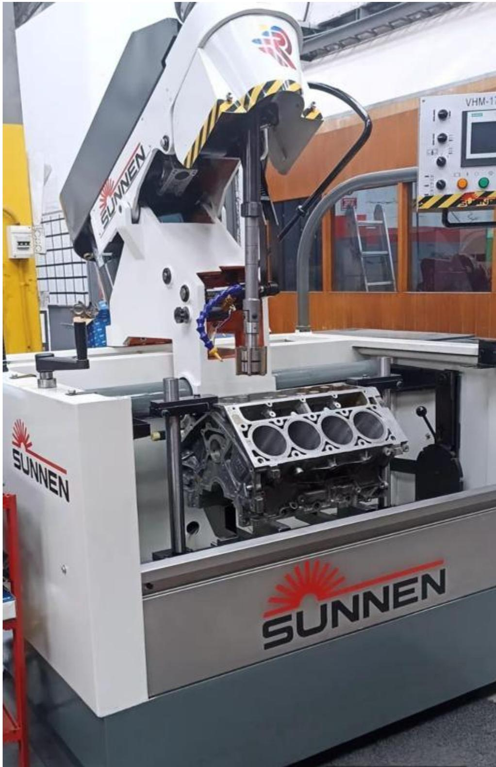
Imagen 15: Maquina de bruñir cilindros por diamante con tecnología CNC
