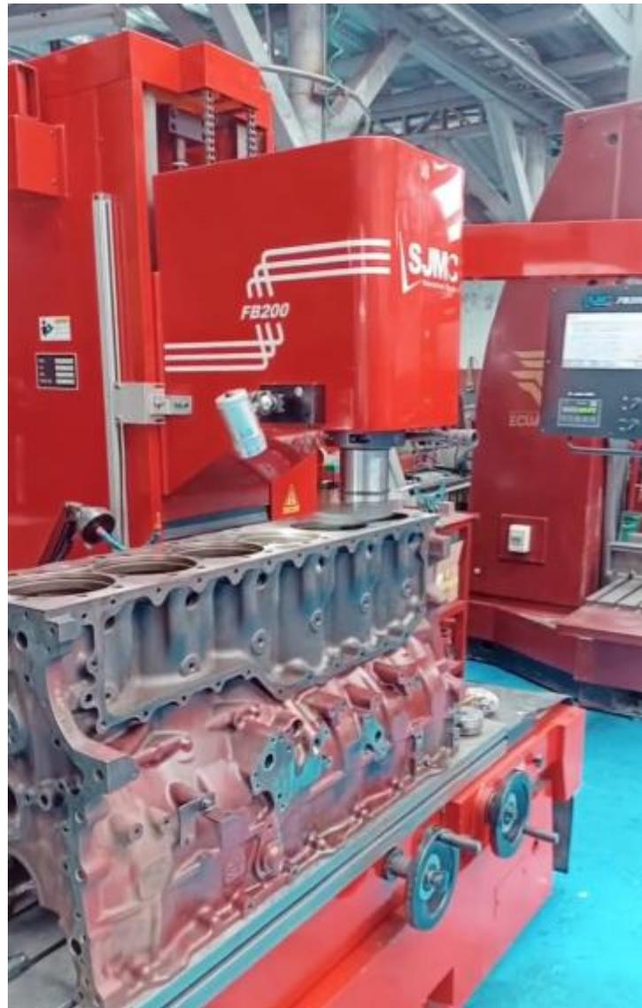
Imagen 14: Maquina de rectificar cilindros y cepillar superficies plana con tecnología CNC
