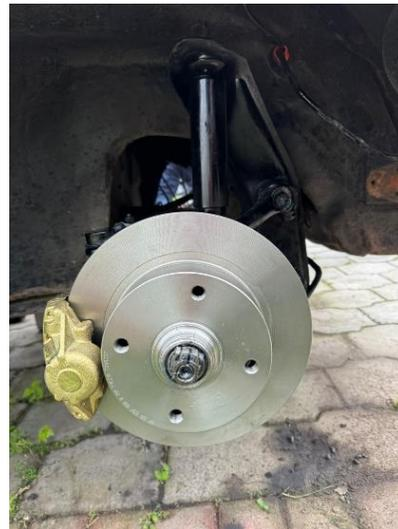
Con estos componentes mencionados anteriormente, se debe cambiar las cañerías de freno y purgación de aire dentro del sistema para su correcto funcionamiento.
