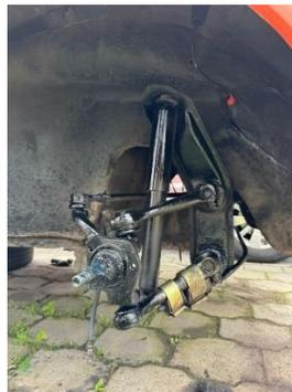
Una vez anclada la placa se procede a instalar el disco de freno junto a la mordaza, la cual va a ir sujeta a directamente a dicha placa mencionada.
