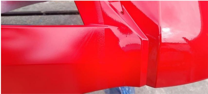
6. Luego se procedió a realizar una segunda aplicación con ambas pistolas y se ve una mejora notable en cuanto al uso de la pistola eléctrica SnapFresh, se visualiza un mejor aspecto y poca diferencia con relación a la calidad del acabado de ambos sistemas de aplicación de pintura, ver figura 38.
