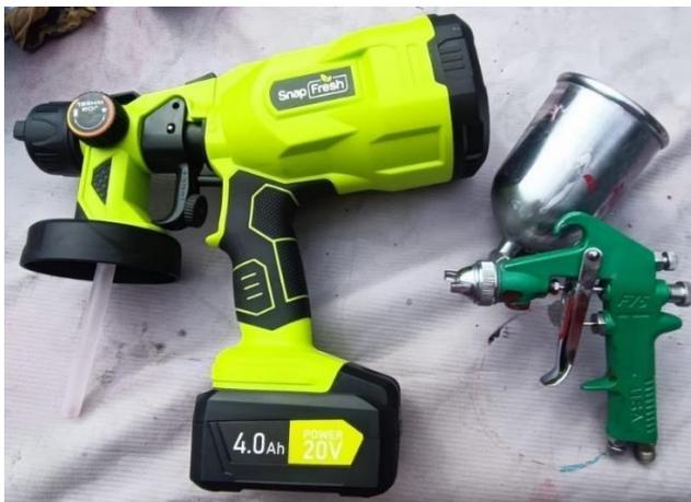
2. Seguido se procede a realizar la aplicación del fondo de la pintura de pintura automotriz tipo poliuretano para plástico en la mitad de la chapa con el equipo de SnapFresh Power y la otra parte con la pistola tradicional de compresión de aire, ver figura 34.
