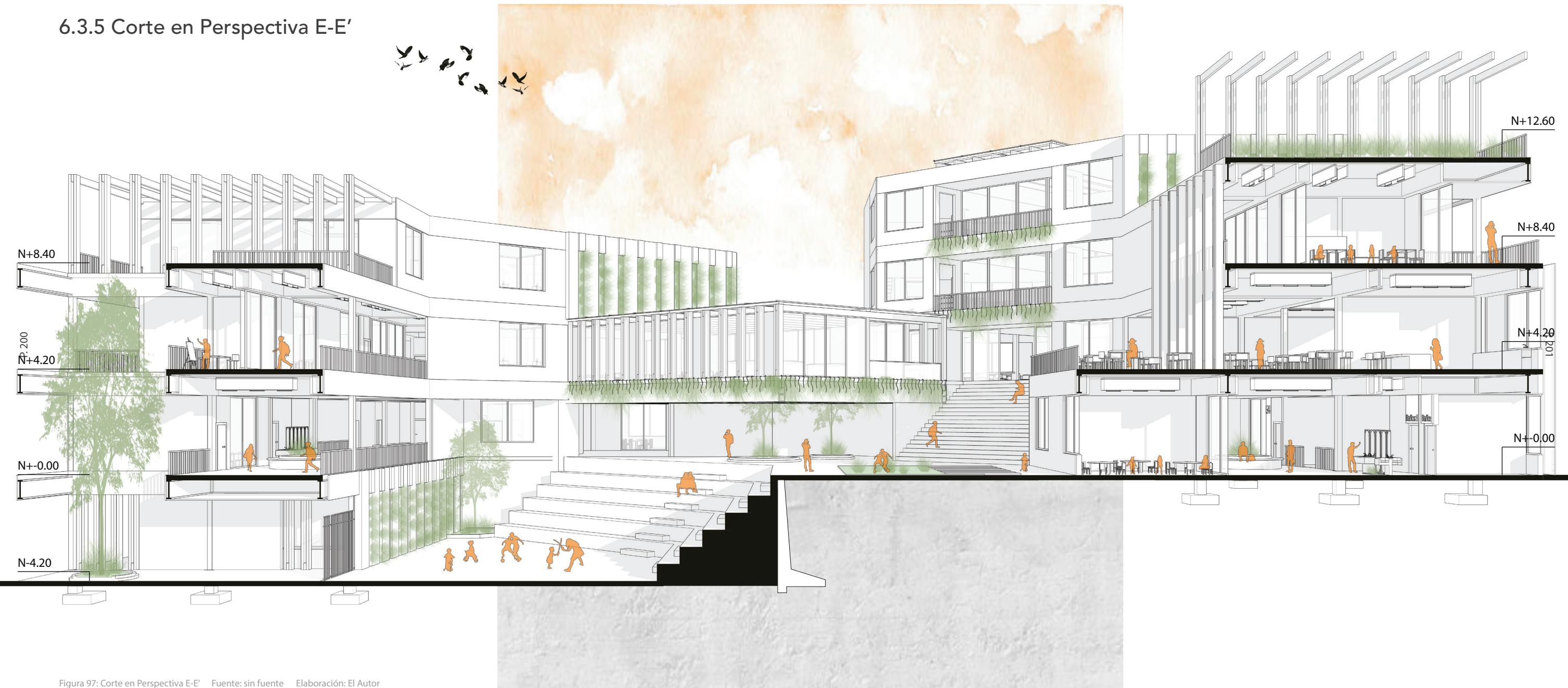
Figura 97: Corte en Perspectiva E-E' Fuente: sin fuente Elaboración: El Autor
