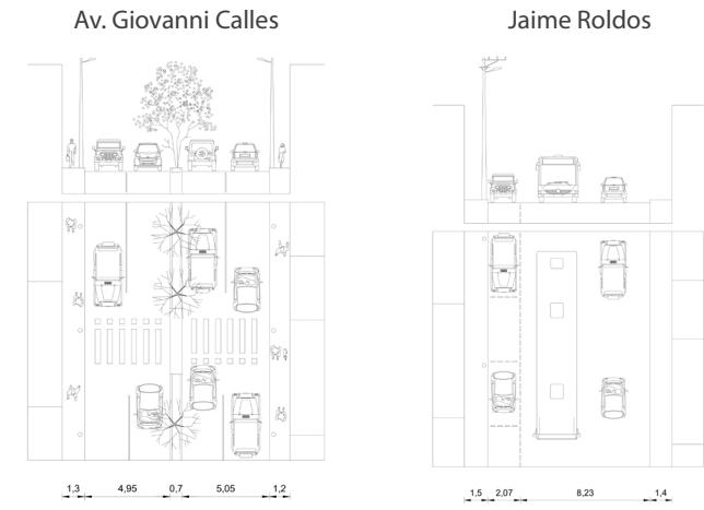
Figura 15: Corte y Planta / tipologías de vías principales Fuente: Visita al Barrio Elaboración: El Autor
