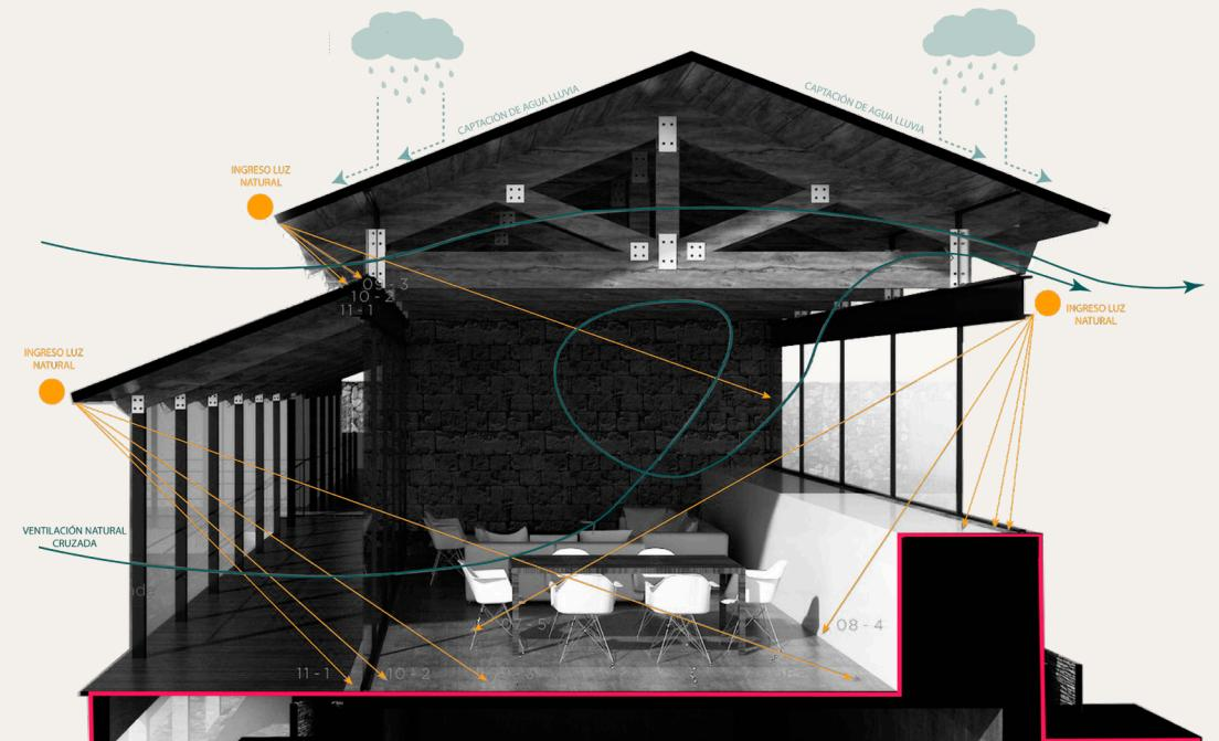
Figura 77: Planta eficiencia energética El Humedal Fuente: TAAR 2013, modificado por el autor 2024
