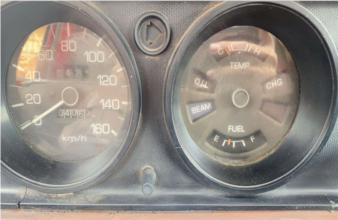
Anexo 4 Medidor de carga y temperatura de motor
