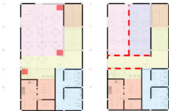
Figura 166- División mediante Panel divisorio móvil
