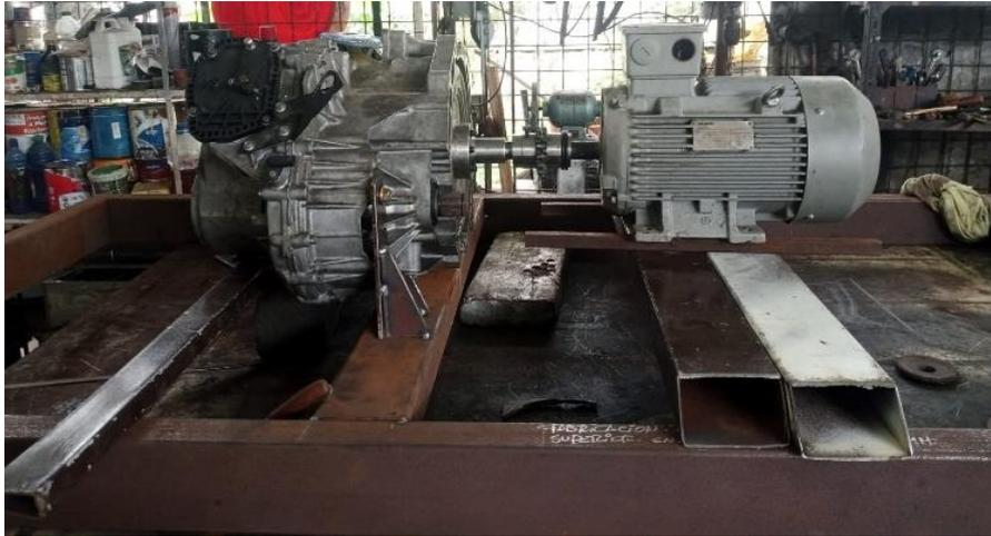
Luego se procedió a la construcción del acople para el volante de inercia de la caja automática el cual implicó un proceso detallado y preciso para garantizar una conexión óptima. Se llevó a cabo un diseño cuidadoso, considerando las dimensiones y especificaciones técnicas necesarias para el acople. Se utilizaron materiales de alta resistencia y se aplicaron técnicas de mecanizado precisas para garantizar la compatibilidad perfecta entre el volante de inercia y la caja automática.
