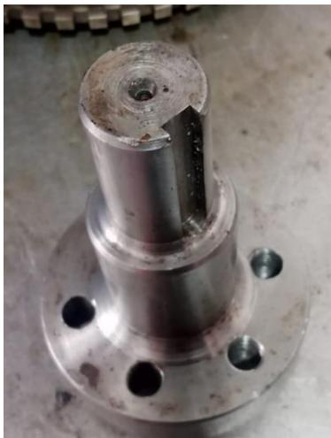
Este acople fue fabricado con el objetivo de asegurar una unión firme y estable, esencial para el correcto funcionamiento y transmisión efectiva de energía entre el volante de inercia y la caja durante las pruebas y operaciones.
