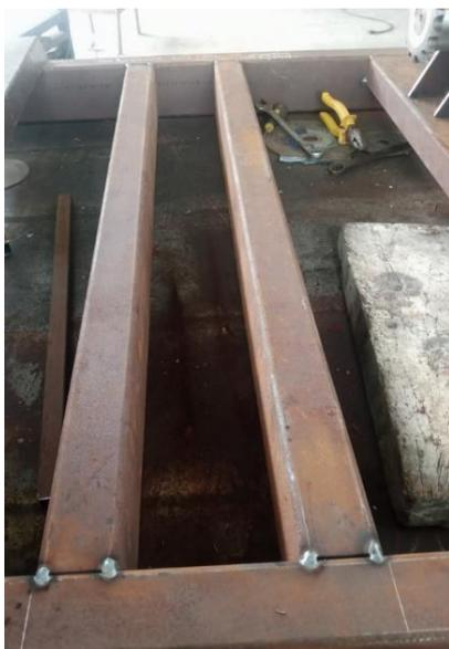
El proceso de nivelación de la caja con la estructura se ejecutó con atención a los detalles, verificando minuciosamente la alineación horizontal y vertical de la caja con respecto a la estructura. Se utilizaron dispositivos de nivelación específicos para ajustar con precisión la posición de la caja, garantizando que estuviera perfectamente alineada y en un plano óptimo con la estructura circundante.
