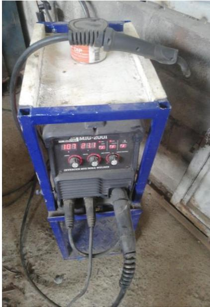
El uso de esta soldadora MIG, con sus características técnicas avanzadas, garantiza una soldadura precisa, eficiente y de calidad en la fabricación del banco de pruebas, asegurando la integridad estructural requerida para soportar las pruebas de la caja automática DSG7 con fiabilidad y precisión.
