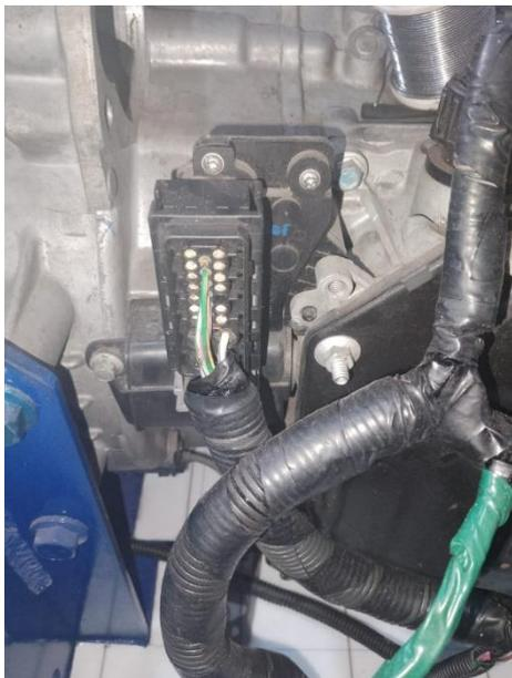
La función principal de este arnés es proporcionar fiabilidad a la interfaz de transmisión de datos críticos, relacionados con el funcionamiento y el estado de la transmisión DSG. Estos datos pueden incluir información sobre la velocidad de rotación de los engranajes, la
