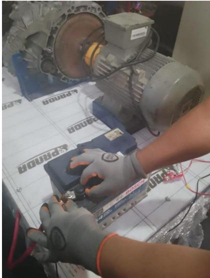
En el caso de que el nivel de voltaje caiga por debajo de los 12.5V especificados, esto indica un deterioro o fallo en la fuente de alimentación, lo que podría resultar en un mal funcionamiento del banco de pruebas DSG. En tales circunstancias, se recomienda reemplazar la fuente de alimentación de manera oportuna para evitar interrupciones en las pruebas y garantizar la fiabilidad de los resultados obtenidos.
