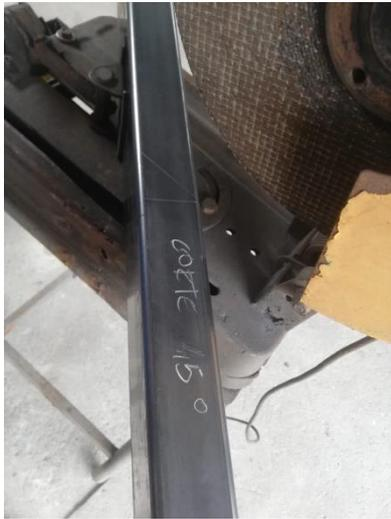
Este método de corte angular no solo brinda solidez a la estructura, sino que también contribuye a maximizar la eficiencia y seguridad del banco de pruebas, asegurando así una plataforma robusta y confiable para llevar a cabo las pruebas requeridas en la caja automática DSG7.
