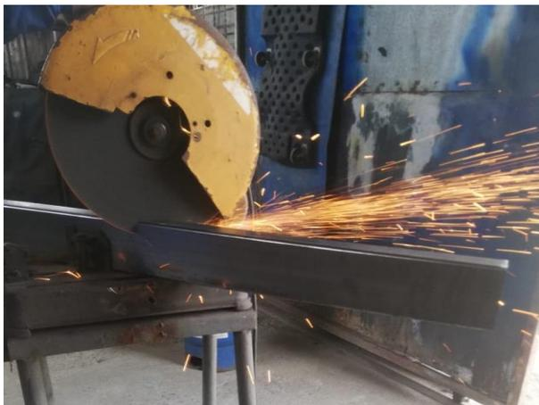
Luego de haber marcado e identificado los tubos que vamos a cortar se procede a llevarlos al disco de corte y realizar dicho corte para posteriormente soldarlos, tal como se puede observar en la figura 9.
