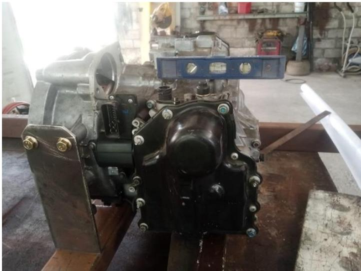
Luego se alineo el motor con la transmisión sobre la estructura, esta alineación precisa fue esencial para optimizar la transferencia de energía y el rendimiento durante las pruebas, asegurando un funcionamiento sin problemas y resultados precisos en el banco de pruebas para la caja automática DSG7.
