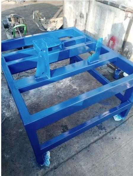
La finalización y pintura de la estructura no solo representaron el cierre exitoso de la fase de construcción, sino que también proporcionaron una apariencia profesional y una protección integral para el banco de pruebas destinado a las pruebas de la caja automática DSG7.
