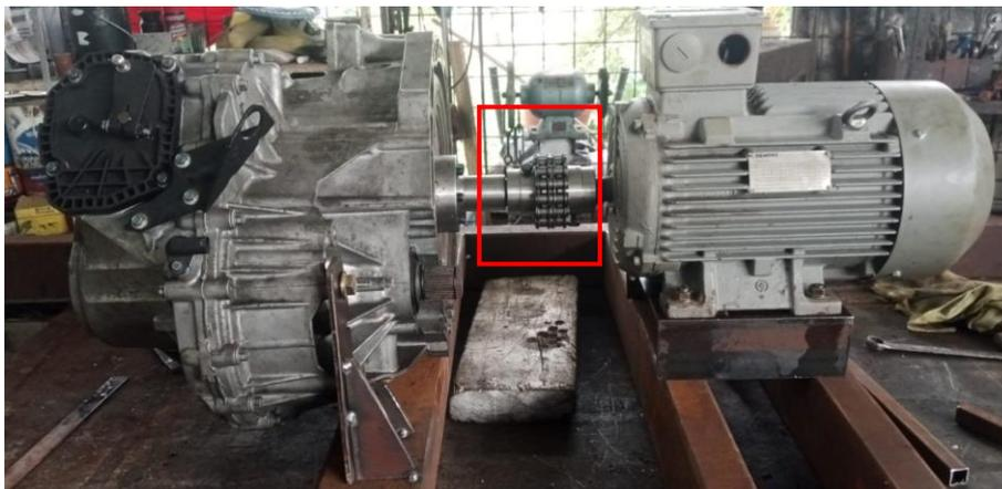
Este método permitió transmitir eficientemente la energía del motor a la caja, asegurando una operación fluida y efectiva durante las pruebas y operaciones del banco de pruebas. El diseño y montaje precisos de este acople de cadena garantizaron una unión robusta y estable entre ambos componentes, proporcionando la integridad necesaria para el correcto funcionamiento y la transmisión adecuada de fuerza y movimiento entre el motor y la caja automática.
