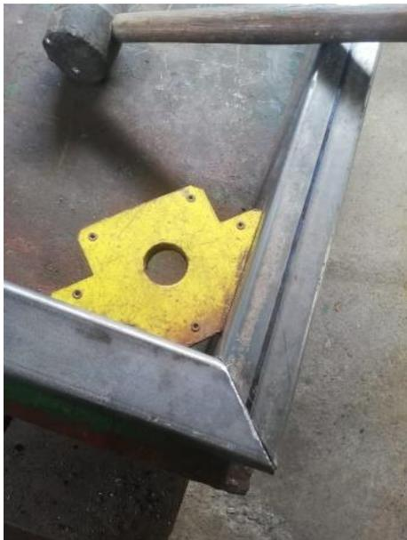
Una vez verificado que los tubos estén rectos y en contacto total en las superficies comprometidas, se establece una conexión robusta y sin holguras. Esta precisión en la unión no solo asegura la funcionalidad adecuada de la estructura, sino que también fortalece su capacidad para resistir tensiones y cargas específicas, cumpliendo así con los requisitos
