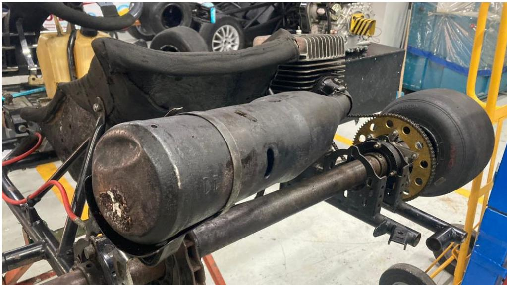
Luego, se utilizan herramientas de medición como calibradores para obtener dimensiones precisas de cada componente, incluyendo el diámetro interno y externo de los tubos, la longitud total, y las curvaturas. Se registran también las posiciones relativas de los componentes, como el silenciador y los conectores como se puede apreciar en la figura 10.
