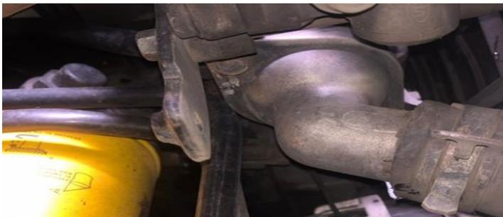
La localización del termostato en el vehículo Hyundai H1, este se encuentra ubicado debajo de la bomba hidráulica como se muestra en la figura 11, está cubierta por la toma de agua que sale
