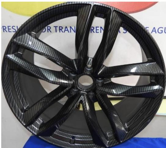
Se debe resaltar que en algunos casos se pueden presentar problemas en la aplicación del proceso de hidrografía por inmersión en accesorios metálicos automotrices, tales como por ejemplo la imprimación de forma inadecuada en la chapa metálica de uso automotriz que se pueden dar por muchos factores como la contaminación de la lámina que se produce de forma muy común por la presencia de agua y el sudor de la persona que esta realizando la aplicación de la imprimación.
