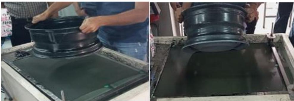
9. Es importante destacar que en algunos casos se puede presentar, imperfecciones en el acabado final, es decir no se logró la imprimación correcta de la lámina en la chapa metálica,
