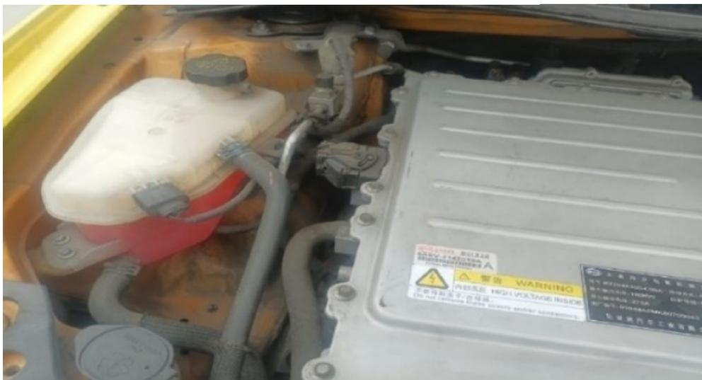
*Nota: Vista del sistema de inversor del vehículo eléctrico BYD e5-400, junto con el sistema de refrigeración activa por líquido, ilustrando la disposición y conexión de los componentes relacionados con la gestión térmica del vehículo.*
