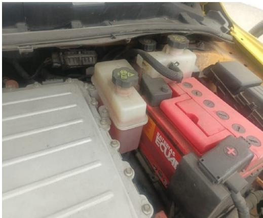
**Nota:** Vista del sistema de refrigeración y el inversor del vehículo eléctrico BYD e5-400, mostrando la configuración del sistema de gestión térmica y componentes clave
