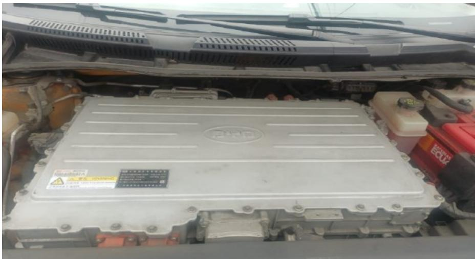
*Nota: Vista del inversor de corriente del vehículo eléctrico BYD e5-400, junto con el sistema de refrigeración activa por líquido y la batería, mostrando la disposición de los componentes clave para la gestión térmica y energética.*
