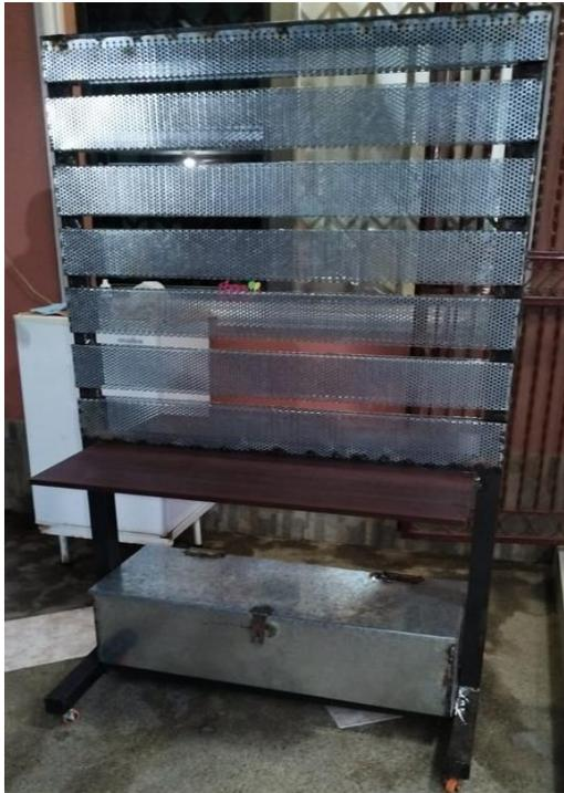
Antes de pasar a la preparación para el proceso de pintura y acabado se deben realizar varias revisiones del estado de la estructura, las uniones de los elementos y la disminución de relieves y malos acabados, así como se puede apreciar en la figura 15 donde se realizó la revisión de los elementos fijados por medio de soldadura.
