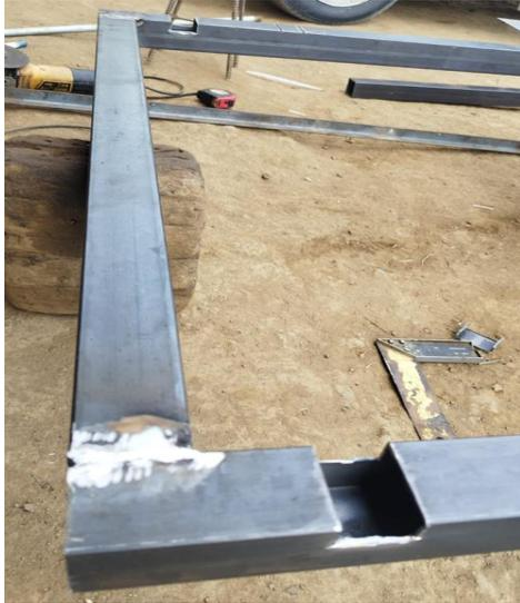
Los rieles van en canales contruidos para ubicarlos de mejor manera en la estructura principal, por ello se fabricó las ranuras como se aprecia en la figura 13, para que los elementos que tendrán movimiento tengan un mejor soporte para la configuración que se desea realizar en ese momento.
