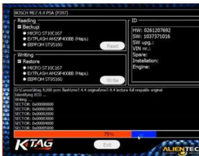
Una vez completada la escritura como se visualiza en la figura 46, el software confirma que el proceso de clonación se ha realizado con éxito. Se verifica que los datos se han transferido correctamente y que la ECU está lista para ser instalada en el vehículo.
