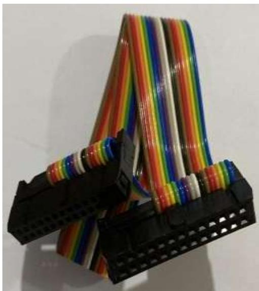
Los cables mencionados en las figuras 16, figura 17, figura 18 tienen 26 pines en ambos extremos, en lo que se diferencian, es que cada uno es compatible con distintos modelos o marcas de los módulos de control.
