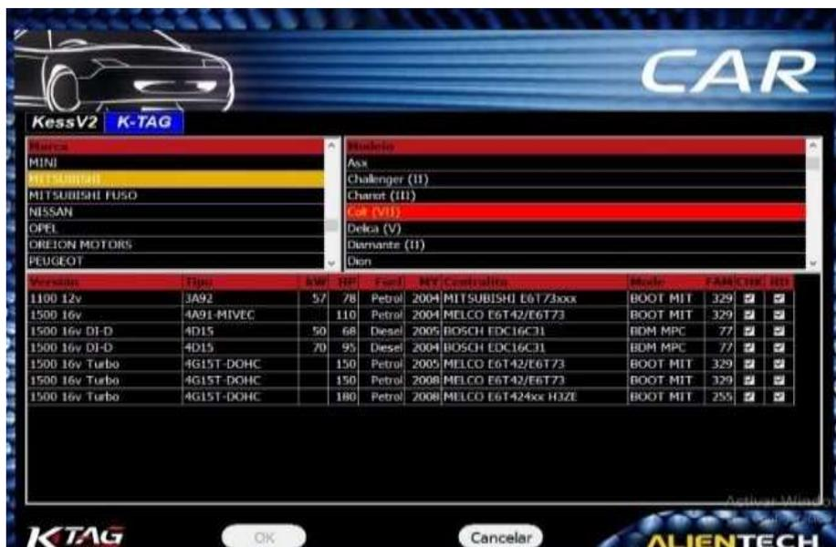
Dentro de estas opciones está el modo BOOT ST que se refiere a una conexión directa entre el pin de este conector al microcontrolador de la ECU. Hay otros dos modos más que son Mode BDM MPC y JTAG REN. El BDM es un protocolo de comunicación utilizado principalmente con microcontroladores, el JTAG REN permite el acceso directo a los pines del microcontrolador para realizar pruebas, depuración y reprogramación del dispositivo.
