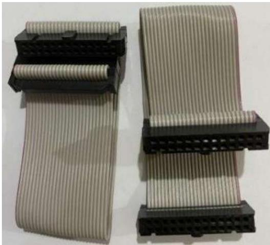
El cable mencionado en la figura 19 tiene 26 pines en un extremo y del otro extremo tiene 10 pines, en la figura 20 este cable tiene 26 pines en un extremo y 14 pines en el otro extremo.
