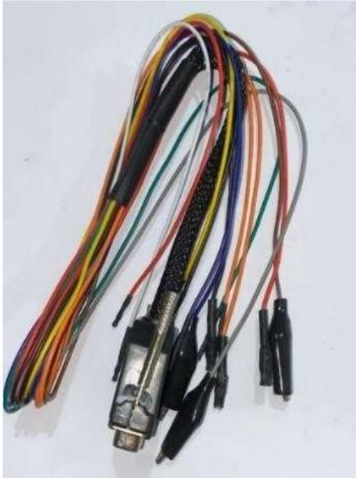
d) *Cable BOOT*: Este cable se usa para conexión modo de conexión directa y se identifica en el KTAG como 14P600KT02.
