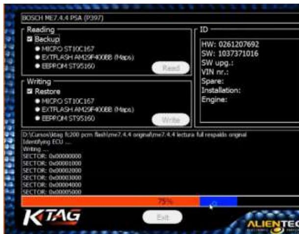
Una vez completada la escritura como se visualiza en la figura, el software confirma que el proceso de clonación se ha realizado con éxito. Se verifica que los datos se han transferido correctamente y que la ECU está lista para ser instalada en el vehículo.
