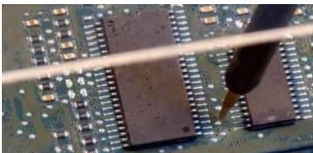
Se procede a conectar la fuente de alimentación de 12V al KTAG y por el otro lado se conecta el arnés como se muestra en la figura 23.
