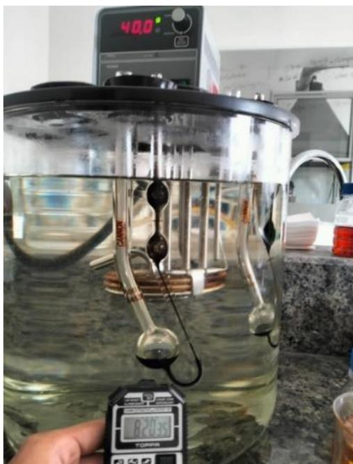
Los tiempos medidos transformados a segundos se multiplicaron por las constantes específicas de cada viscosímetro para calcular la viscosidad cinemática del aceite a las temperaturas ensayadas, donde estas constantes de cada viscosímetro fueron vistas en los certificados de calibración brindadas por el laboratorio, siendo la constante del viscosímetro A453 a 40 °C, 0,22890, y la constante del viscosímetro Y189 a 100 °C, 0,03463.
