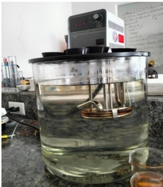
Los viscosímetros se llenaron con la muestra de aceite, previamente batidos para evitar concentraciones, mostrado en la figura 20, de igual manera con la ayuda de la pera de succión. Es crucial que este paso se realice con cuidado para evitar la formación de burbujas de aire, las cuales pueden influir negativamente en la precisión de la medición.
