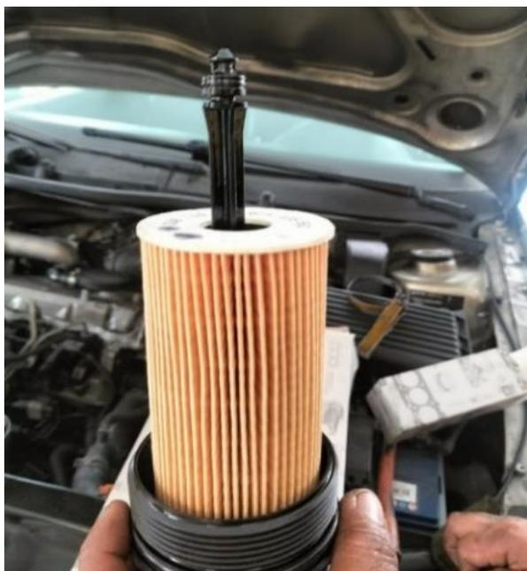
Cambio de Aceite: El cambio de aceite es una parte fundamental en la preparación del vehículo para la toma de muestras y la evaluación de su rendimiento. Este proceso garantiza que el motor funcione con un lubricante limpio y de calidad, esencial para obtener resultados precisos durante el análisis.
