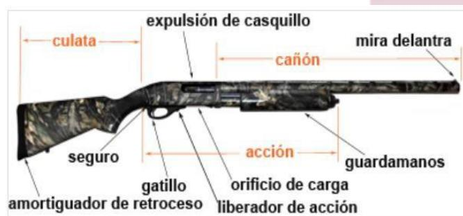
Figura XXIX Partes de una escopeta
