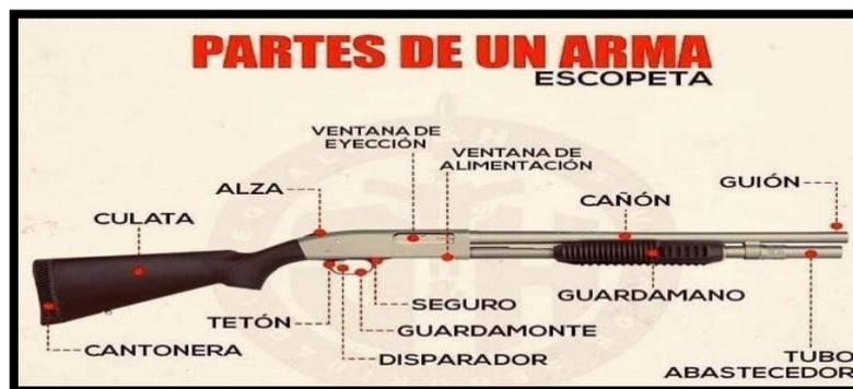
**Ilustración 2** Partes de un arma
