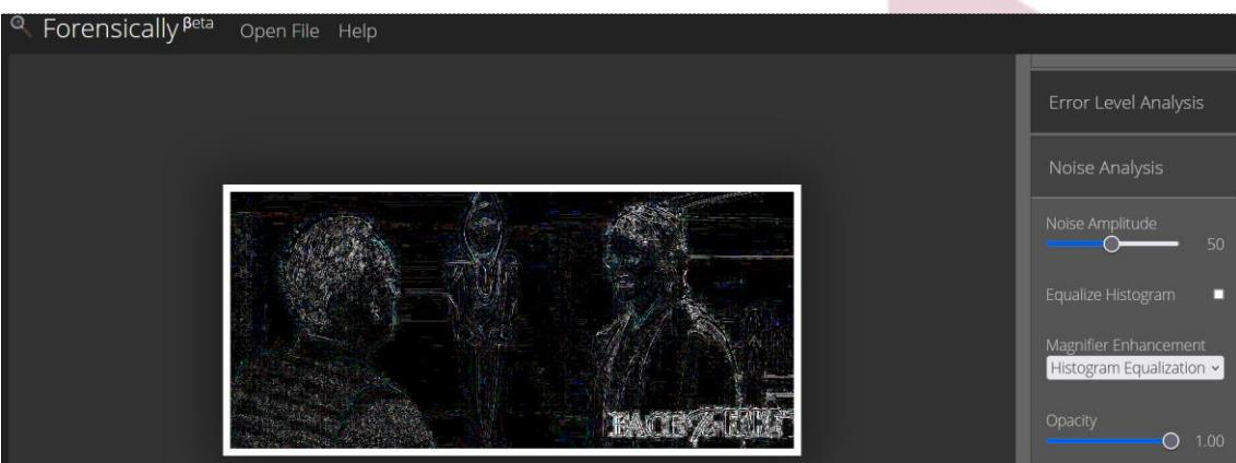
Se emplea esta herramienta para identificar manipulaciones en las imágenes como aerografías, deformaciones y clonaciones con corrección de perspectiva; en el análisis del presente fotograma se utilizó el parámetro de amplitud de ruido, lo que permite que el ruido sea más brillante.
