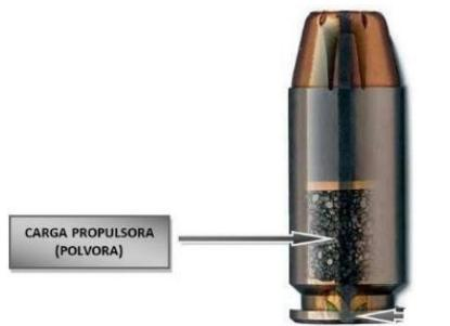
En la Figura 26 muestra el proyectil o bala: en palabras sencillas, es el cuerpo que es arrojado al vacío, muy duro y poco deformable que es lanzado con un arma de fuego, puede ser de diversos tamaños y con una forma esférica o cilíndrica, generalmente de plomo o de hierro.
