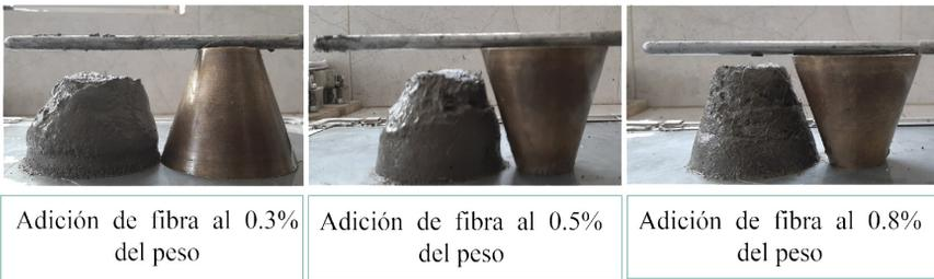
Figura 3. Asentamiento de la mezcla con el 0,3 %, 0,5 % y 0,8 % de fibra
