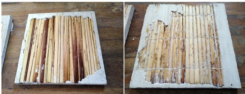
Figura 7. Paneles de yeso-totora, amarrados en bulto y pegados en paralelo
