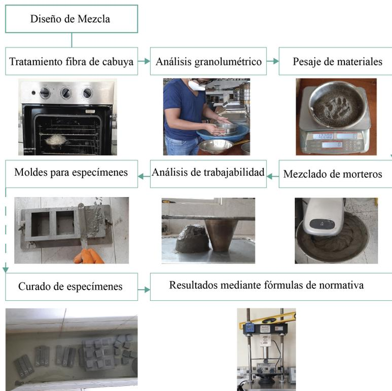
Figura 2. Proceso de diseño de mezcla
