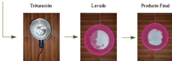
Figura 3. Esquema del proceso de obtención de partículas de polímeros PET
