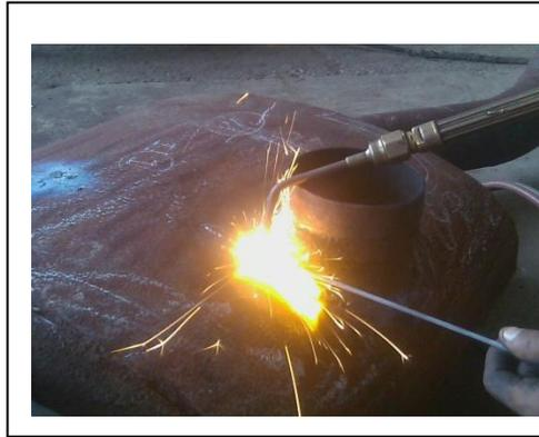
**Figura 2.3 Soldadura Autógena**
