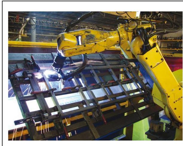
**Figura 2.8 Soldadura robotizada**
