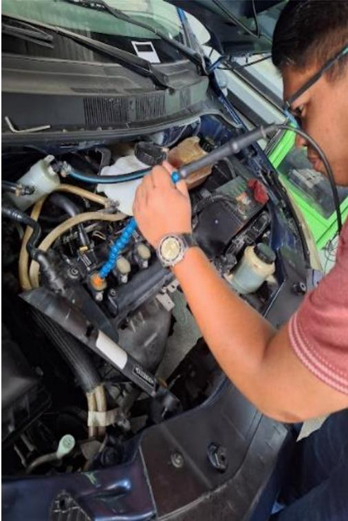
6. Luego de puede apreciar en la pantalla del equipo de diagnóstico FSA 740 las gráficas mostradas en cada bobina las cuales se las puede apreciar en las figuras 30, 31, 32, 33 siendo las gráficas de las figuras de las bobinas 1, 2, 3 y 4 de forma respectiva.
