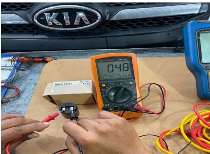
El Solenoide de Fuerza Variable (VFS, por sus siglas en inglés) es un componente crítico en las transmisiones automáticas modernas. Su función principal es regular la presión del fluido hidráulico dentro de la transmisión, lo cual es esencial para un cambio de marchas suave y eficiente. El solenoide VFS ajusta la presión del fluido en respuesta a las señales del módulo de control de la transmisión (TCM).
