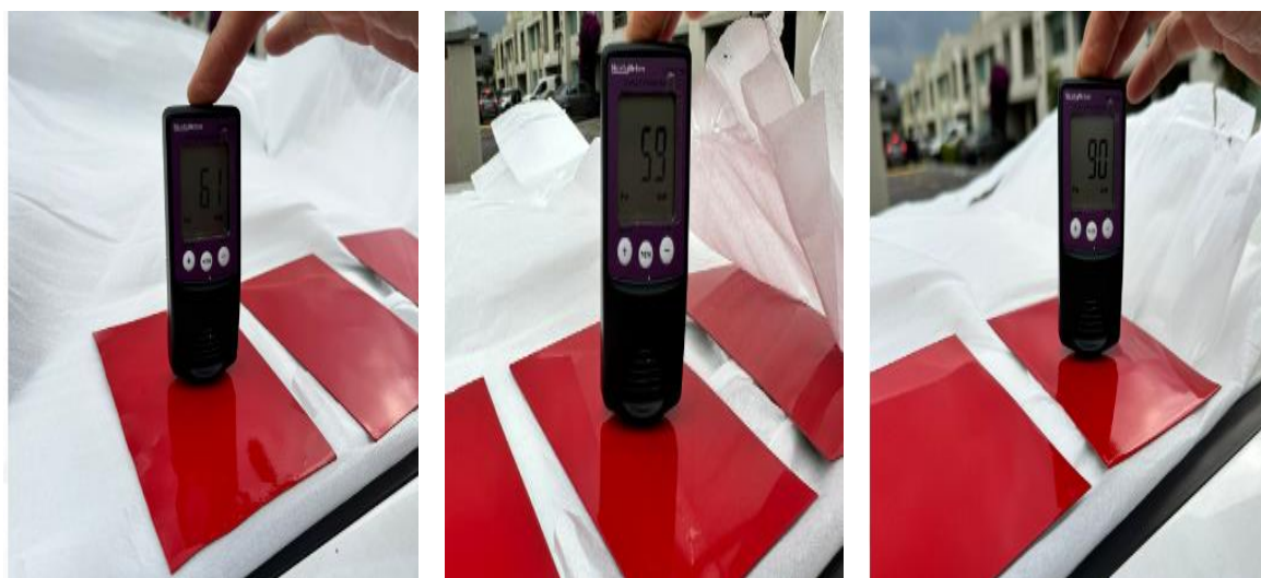
Figura #12 Medición de espesor de pintura.
