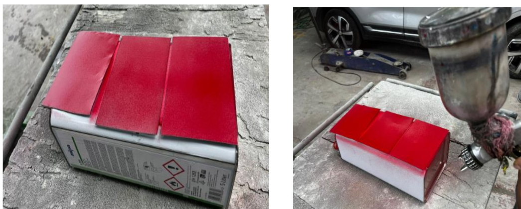
Figura #10 Aplicación del pigmento (pintura).
