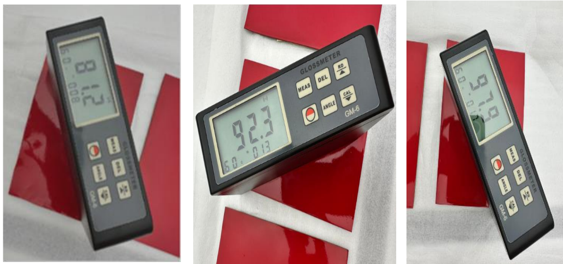
Figura #13 Medición de brillo de las placas.
