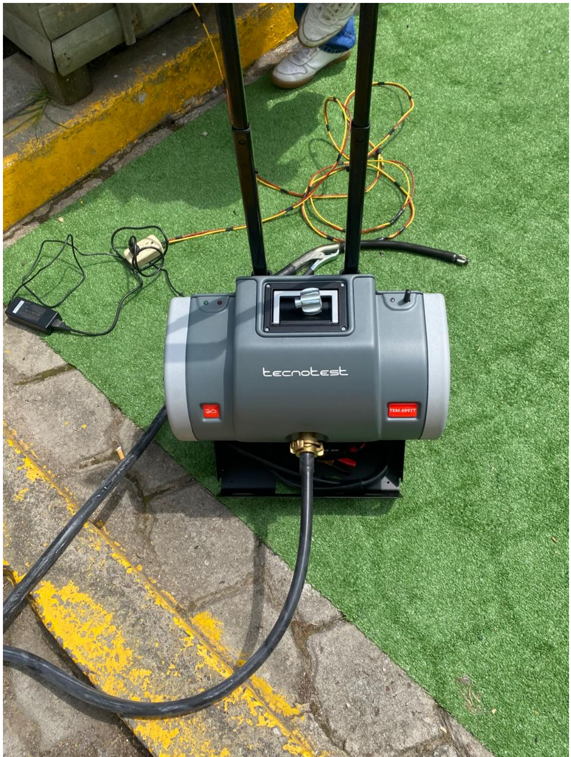
Anexo 13 Opacímetro instalado.
