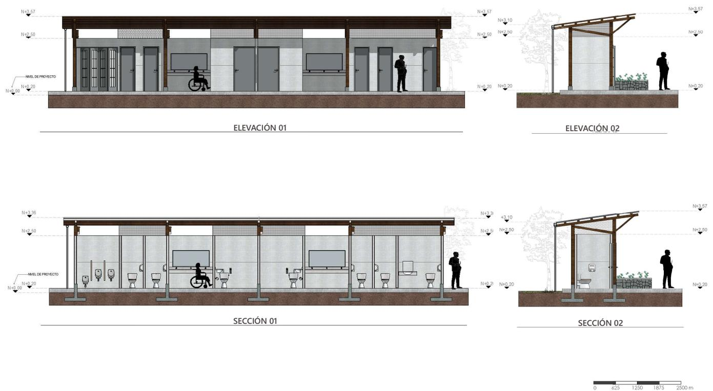
Figura 65. Elevaciones - secciones baterías sanitarias.
