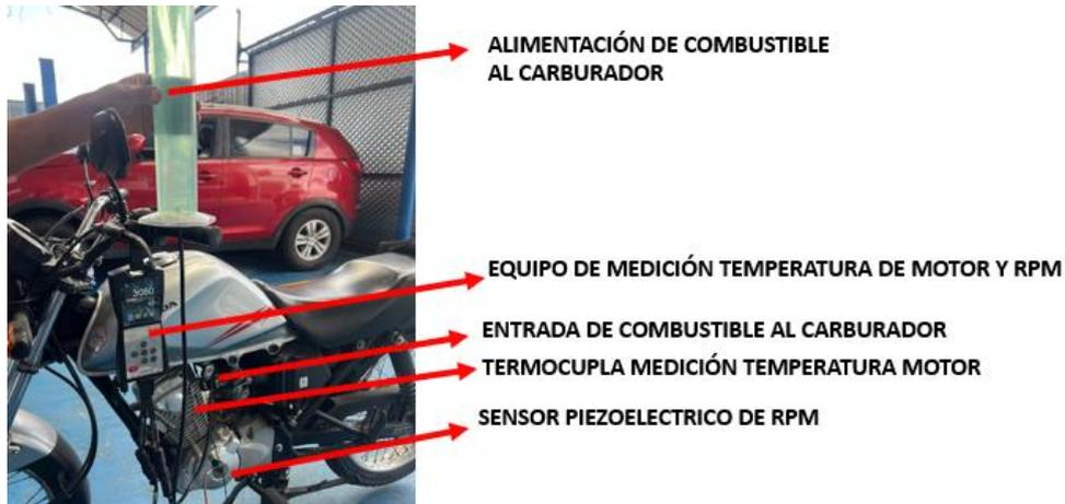
Una vez realizadas las conexiones, se procede con las pruebas.
