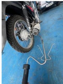
A continuación, se presentan los resultados de cada prueba capturado a los 30 segundos de introducir el analizador de gases en el tubo de escape.
