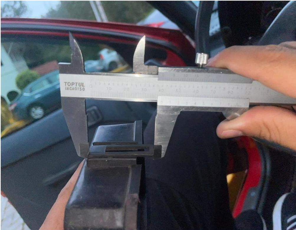
Espesor entre seguro y tapa de fusibles
