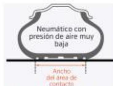
Fig 4 Área de contacto neumático.
