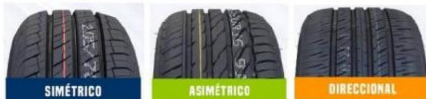
**Nota.** La figura muestra el tipo de llanta con una banda de rodadura simétrica, asimétrica y direccional. Tomado de: "¿Cuántos tipos de neumáticos para coche existen?," Auto10.com | Expertos en coches. [Online]. Available: <https://www.auto10.com/reportajes/cuantos-tipos-de-neumaticos-para-coche-existen/5412>.
