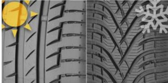
**Nota.** La figura muestra el tipo de llanta para verano y de invierno. Tomado de: “¿Cuántos tipos de neumáticos para coche existen?,” Auto10.com | Expertos en coches. [Online]. Available: <https://www.auto10.com/reportajes/cuantos-tipos-de-neumaticos-para->
