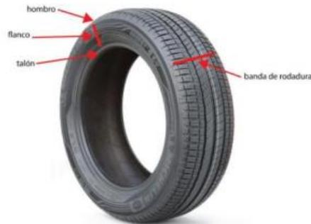
**Nota.** La figura muestra las secciones y zonas que componen una llanta. Tomado de: J. L. Gómez, "¿Cuáles son los diferentes elementos que conforman un neumático? Descubre todos sus secretos." *Diariomotor*, 17-Mar-2020. [Online]. Available: <https://www.diariomotor.com/que-es/mecanica/neumatico-elementos/>.
