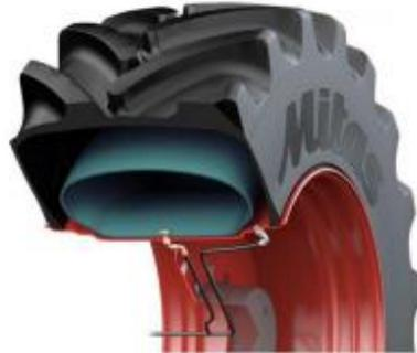
*Nota.* La figura muestra el tipo de llanta con cámara en el interior. Tomado de: "¿Cuántos tipos de neumáticos para coche existen?" Auto10.com | Expertos en coches. [Online]. Available:
