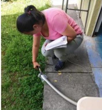
Figura 7. Mediciones de gases contaminantes en la manguera de escape
