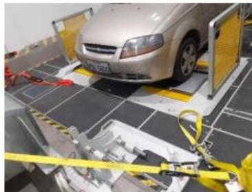
Fijar el vehículo al dinamómetro por medio de correas de tensión al gancho de remolque, juntamente con los seguros de las ruedas posteriores.
