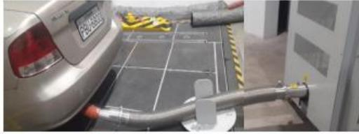
Los gases ya mezclados pasan a la primera etapa del equipo de disolución (CVS-7400S) mediante el cual son disueltos por el aire que entra de la atmosfera en una concentración específica (flujo constante) se obtiene una lectura correcta.
