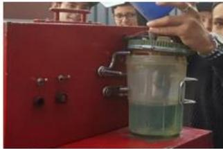
Figura 7. Bomba gasolina Externa
