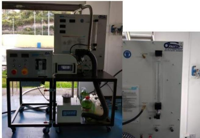
Figura 4. Verificación de combustible en los depósitos antes del arranque del motor CT 150
