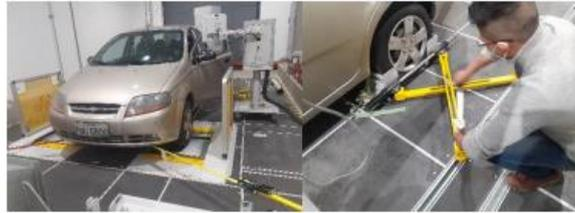
Instalar la boquilla al final del tubo de escape y el colector de gases.
