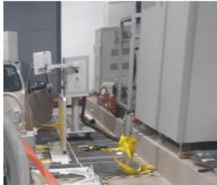
Ya diluidos los gases pasan a la fase de recolección en el muestreador de flujo constante, existe tres bolsas para cada gas, aire, gasolina, diésel.
