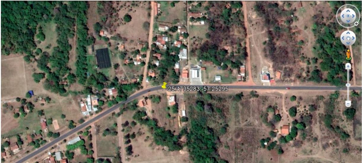
Se trata de una ruta de pavimentación asfáltica en regular estado de conservación, con trazado de curva sin pendiente de consideración, con dos sentidos de opuesta circulación separados por doble franja de vieja data, sin banquetas a ambos lados, la visualidad conforme al trazado de la vía es óptima, el entorno corresponde a una zona urbana.-
