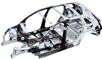
Nota: La fotografía representa los componentes de acero de ultra alto límite de conformado en caliente, partes en anexo 6, tomado de (Domínguez, 2021)
