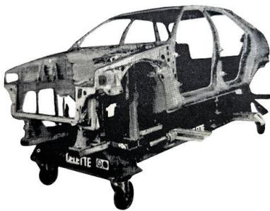
Nota. Carrocería autoportante montada sobre bancada, tomado de Manual de Mantenimiento y Reparación de Vehículos Tomo1 (p.104), por Valbuena, 2008
