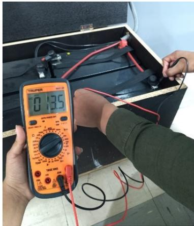
*Figura 21: Análisis estado baterías ciclo profundo.*
