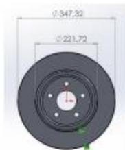
Fig. 2. Diámetro interior y exterior del disco.
