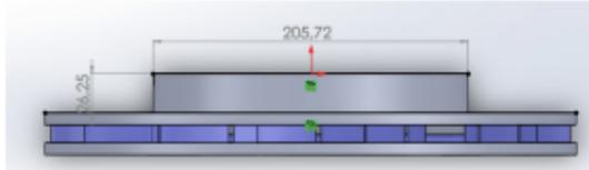
Fig. 7. Espesor y diámetro de la campana del disco.
