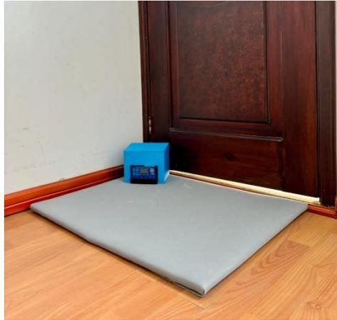
**Figura 20:** *Filtro hecho a base de desechos textiles ubicado sobre el tapete.*
