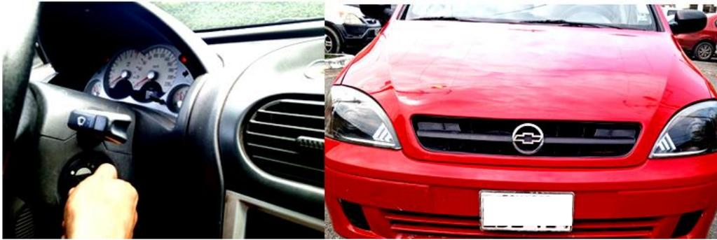
*Beneficios de Seguridad:* Las luces diurnas están diseñadas para aumentar la visibilidad del vehículo durante el día como se muestra en la figura 77, reduciendo el riesgo de accidentes. Evaluar si la implementación de luces diurnas contribuirá significativamente a la seguridad del vehículo y de sus ocupantes. La normativa indica que las luces que deben utilizar deben ser de color blancas o amarillas.
