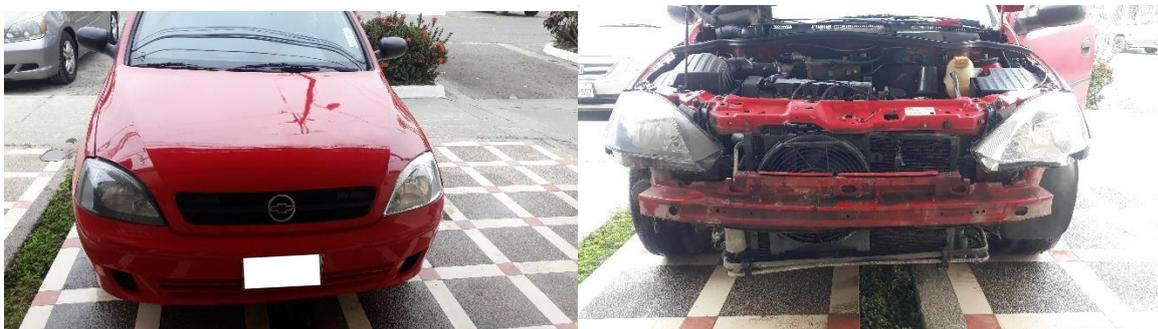
*Se procede a la extracción de los tornillos que aseguran los faros:* ver figura 67 para conocer donde se encuentra los puntos que sujetan los faros, con el objetivo de liberarlos de su posición actual. La retirada de estos elementos de fijación es esencial para permitir la
