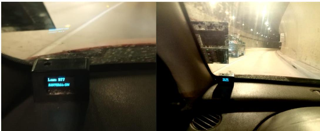
*La exposición del sensor en la noche:* Durante la noche, el sensor incrementa su umbral de detección, como se observa en la figura 83, alcanzando un valor de 1023. Este ajuste facilita la activación y la permanencia del sistema en funcionamiento durante ese período
