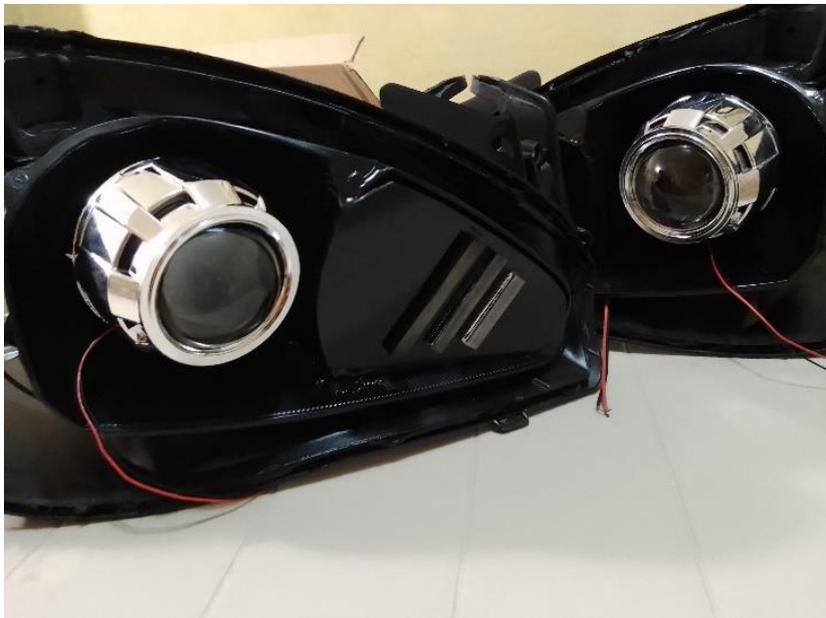
*Ubicación de los cables de las luces que conforman el faro:* Mediante la utilización de un multímetro, se procede a la identificación de las líneas correspondientes a las luces de cruce, alta y la conexión a tierra. Estas líneas serán integradas en un conector adicional de tipo H4,
