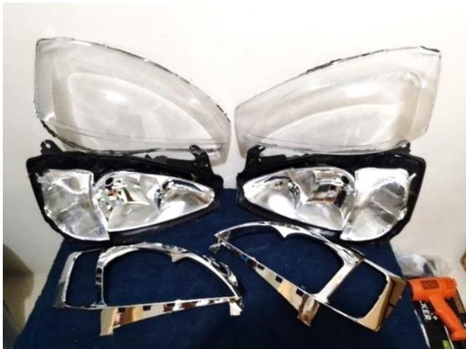
La uniformidad en la aplicación de este proceso garantiza que ambas unidades sean tratadas de manera equitativa y que la separación entre el molde cromado y la mica se realice de manera consistente en ambos faros.
