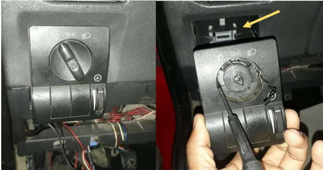
Se desconecta el conector de su posición liberando las vinchas de sujeción. En la figura 53 muestra que este paso proporcionará una mejor visión y acceso al socket del conmutador de luces.
