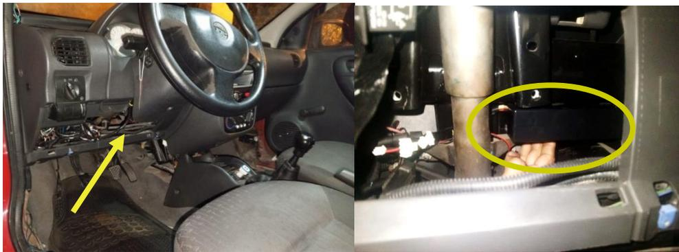
Para llevar a cabo la conexión eléctrica entre el módulo y las conexiones en el vehículo, se utiliza el arnés señalado en la figura 51. Este componente específico facilita una conexión eficiente y segura, asegurando la integración adecuada del sistema en la red eléctrica del vehículo.
