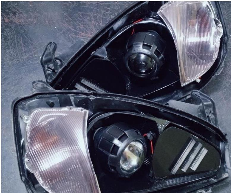
Sellado del faro: para llevarlo a cabo se emplea silicona en la base del faro. El propósito principal es prevenir cualquier sellado inadecuado que podría dar lugar a la entrada de humedad en el interior del faro. Este proceso asegura que el faro, con las adaptaciones y mejoras implementadas, esté completamente sellado de manera confiable.
