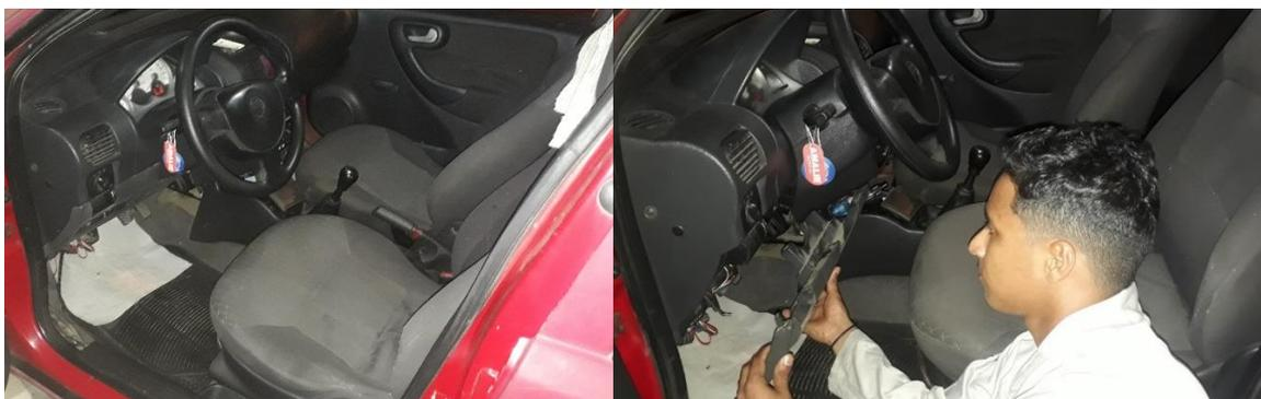
El dispositivo inteligente se fija en la parte interna del tablero como se muestra en la figura 50, específicamente en un travesaño donde no interfiere con ningún componente o estructura del cableado del vehículo. Este emplazamiento estratégico ha sido seleccionado para facilitar su acceso y manipulación en caso de ser necesario, garantizando una instalación conveniente y libre de interferencias con otros elementos del vehículo.
