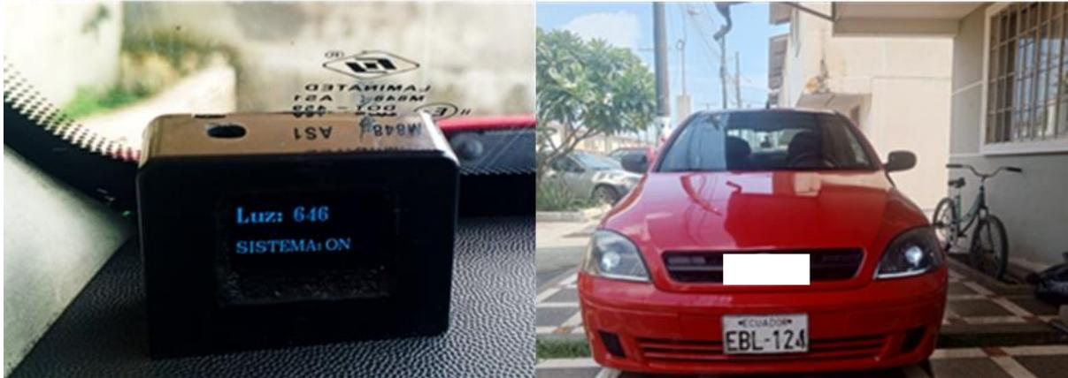
*Exposición luz en el día:* Durante la exposición a la luz del día, se realiza una prueba para verificar la viabilidad del sistema autónomo de luces. El sensor de luz registra un valor umbral de 120 mientras está directamente expuesto al sol. Este valor es notablemente menor que el umbral especificado de 600, indicando que las condiciones de iluminación son lo suficientemente intensas como para desactivar el sistema.
