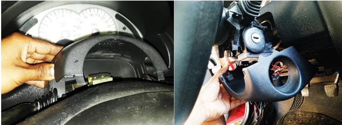
Este paso brinda acceso al interruptor de encendido, donde se realiza la conexión en el Pin 1 del socket.
