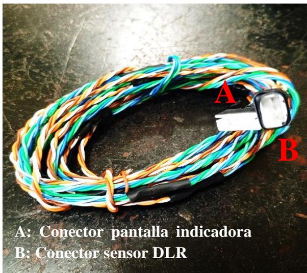
Se inicia desmontando la moldura lateral ubicada en el travesaño delantero izquierdo. Este paso permite un acceso sin obstrucciones al área de instalación. A continuación, se guía el arnés necesario a través del espacio recién creado. Este arnés, claramente identificado en la figura 61, se emplea para la conexión efectiva del sensor DLR y la pantalla indicadora como se muestra en la figura 63.
