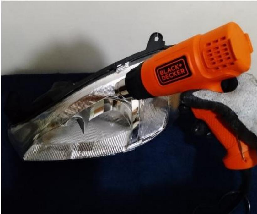
*Separación entre la mica y la base plástica del faro.* En este punto, el uso de guantes resulta imperativo para prevenir posibles lesiones, especialmente quemaduras, dado que la zona aún conserva altas temperaturas debido al proceso de calentamiento. La precaución de utilizar guantes no solo garantiza la seguridad del operador, sino que también facilita un manejo más efectivo y protegido durante la separación.
