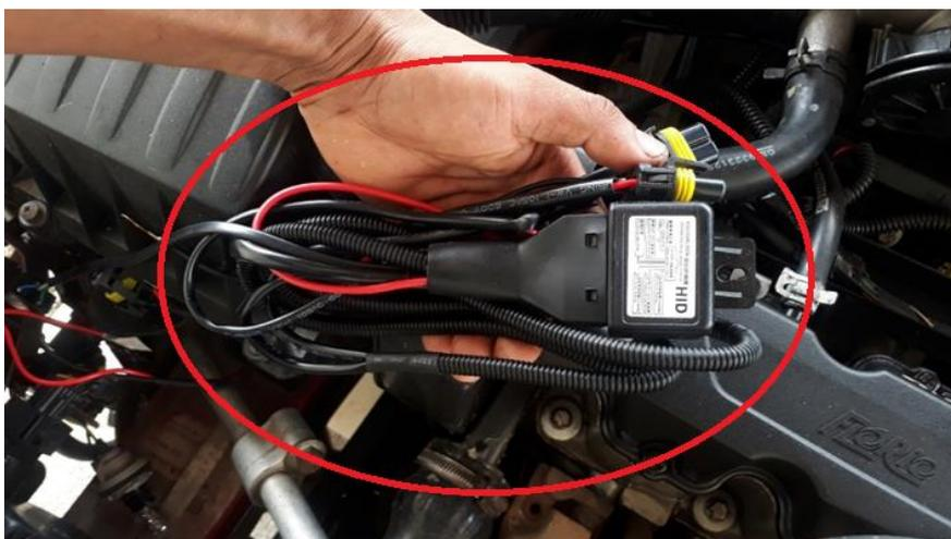
Además, integra múltiples líneas o cables con conectores específicos, indispensables para garantizar el funcionamiento preciso de las luces en los módulos de proyección.
