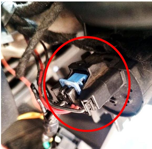
En el Pin 1 del conector, se lleva a cabo la interconexión con el cable positivo proveniente del Conector A, tal y como se detalla en la figura 58. Este cable servirá como
