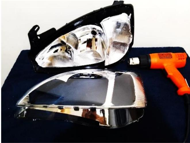
*Separación de los componentes del faro.* Esta ejecución permite abrir ambos faros de manera efectiva, llevando a cabo la separación del molde cromado respecto a la mica o dispersor como se muestra en la figura 35.
