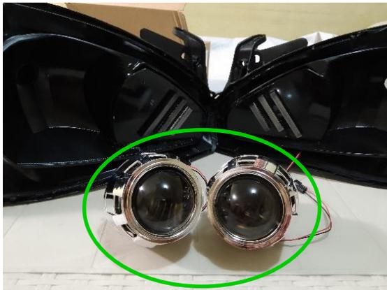
Este kit de módulos se presenta como una solución altamente compatible, especialmente diseñada para faros que poseen una disposición de bombillos H7. La versatilidad de este conjunto facilita su montaje, al mismo tiempo que integra de manera eficiente la función de luz alta y baja. En el caso del faro original del auto Corsa Evolution, que inicialmente está equipado con un bombillo H7 para la luz de baja y un bombillo H1 para la luz alta, este kit representa una innovadora actualización.
