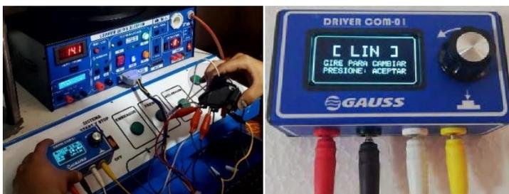
Para finalizar se gira la perilla del Driver COM-01 para variar la señal del protocolo LIN y que el regulador varíe el voltaje de carga baja figura 35, carga normal figura 36 y en sobre carga figura 37.
