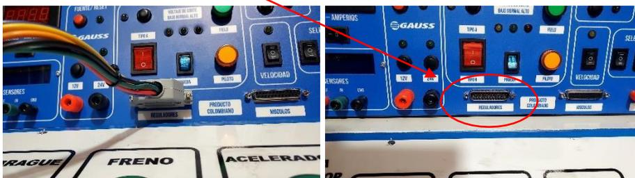
Posteriormente ubicado el socket se procede conectar el regulador de voltaje al laboratorio el cual simulara el funcionamiento del sistema de carga del vehiculo cuano el motor esta apagado, pero con el switch de encendido en la pocision ON, enviado 12v de alimenaction hacia el regulador encendido la luz piloto de color naranja ubicado en el lavoratorio como se visualiza en la figura 26, el cual simula ser el testigo de la bateria en el panel de instumentos del vehiculo.
