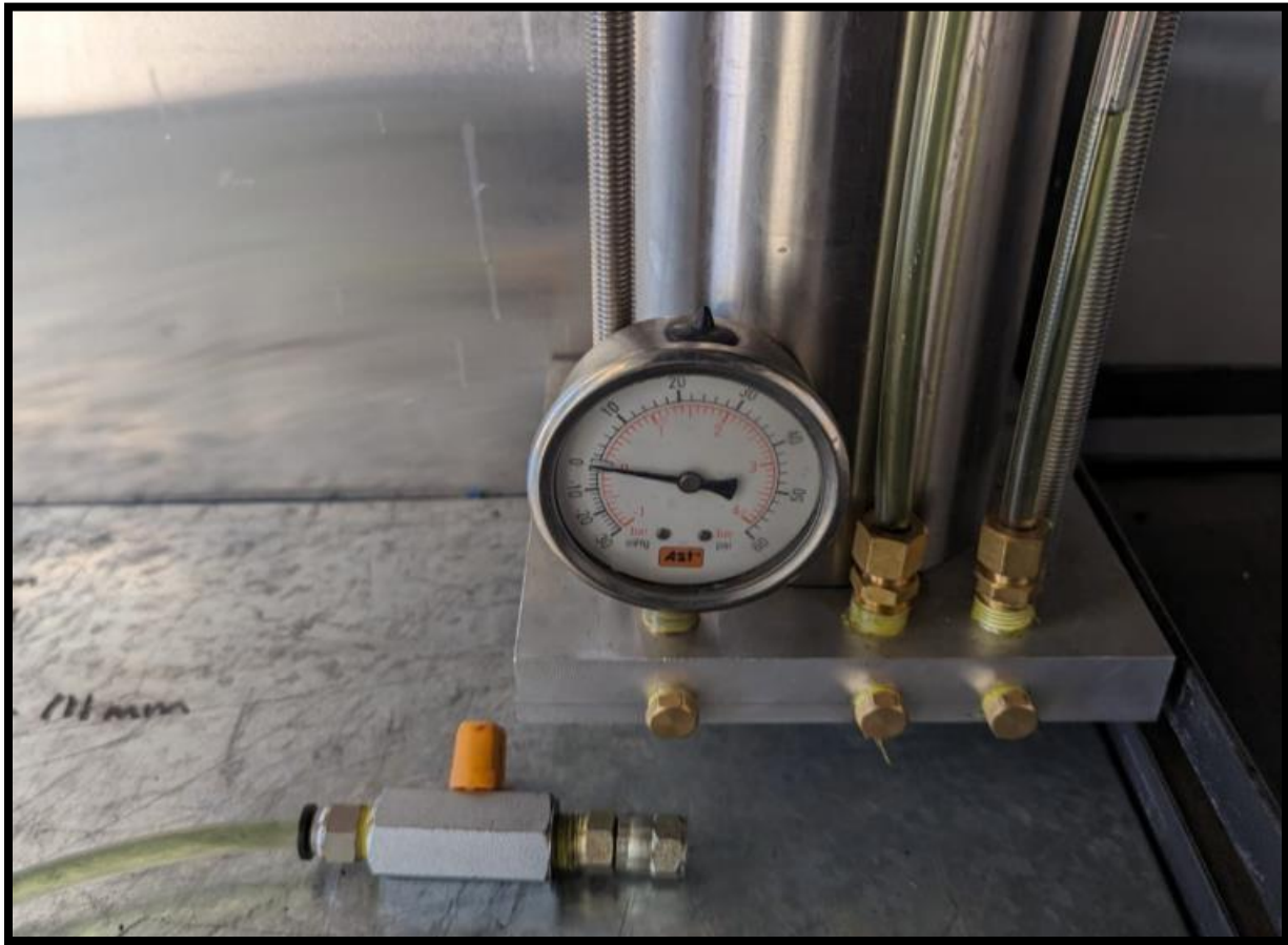
Figura 3. Manómetro principal de la máquina de llenado y vacío
