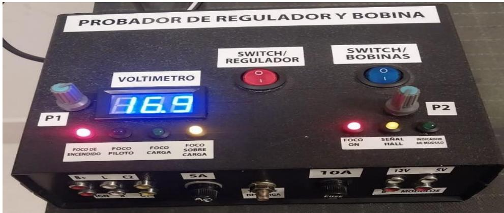
La figura 37, presenta una visión en perspectiva del instrumento desarrollado en este trabajo y que permite realizar mediciones altamente eficientes tanto a reguladores de voltaje como a bobinas de encendido. Esto es, un solo equipo tiene capacidad para hacer una doble función.
