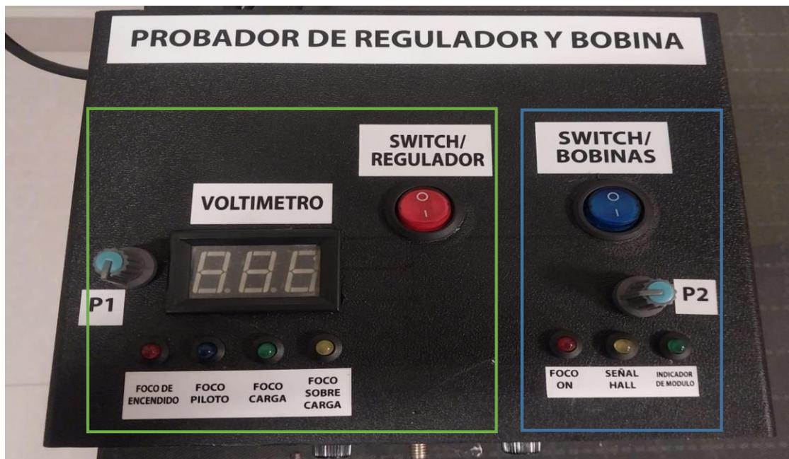
Como se aprecia en la figura 40, los controles para el encendido o apagado del funcionamiento del probador de bobina, son aquellos que están encerrados en la línea de remarcación color blanco (switch, potenciómetro P2 y luces led). Los controles para el probador de regulador, están encerrados con la línea azul (switch, P1 y luces led).
