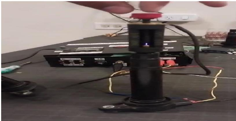
En la figura 45, se aprecia una imagen de la conexión de la bobina con el equipo probador el cual es alimentado de energía por una batería. La bobina no debe calentarse. De igual manera se puede utilizar un módulo conectado a una salida de 5 voltios del equipo, donde se transforma en un pulso de 12 voltios que genera la chispa en la bobina.
