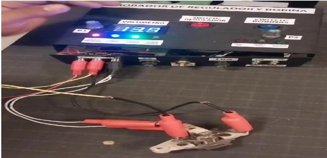
La figura 43, determina la correcta conexión entre el equipo probador y el regulador de voltaje. Así lo evidencia la luz roja, verde y azul del equipo que están encendidas, lo que afianza la instalación y uso del regulador de voltaje para transmitir energía al rotor.
