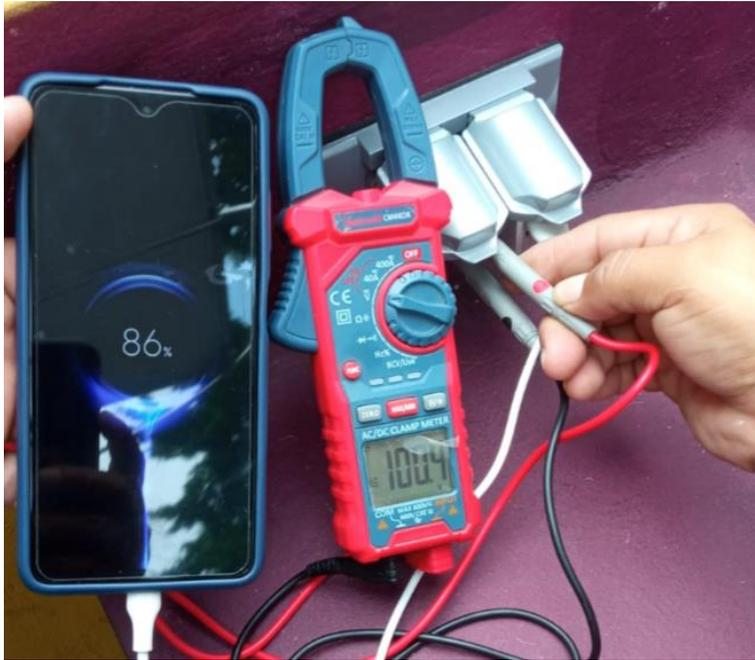
Para una mejor certeza de los datos podemos verificar junto con un multímetro (ver figura 26) que nos da el voltaje necesario para una carga optima del dispositivo, la energía solar es sin lugar a duda lo mejor que se puede hacer en energía renovables ayudamos a disminuir la huella de carbono y a la utilización de bicicletas eléctricas ya que contamos con un árbol solar que podría verse como una electrolinera
