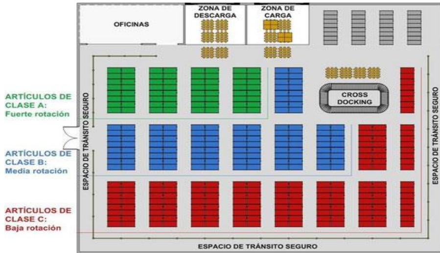
ILUSTRACIÓN 6: DISEÑO DE LAYOUT DE ALMACÉN
