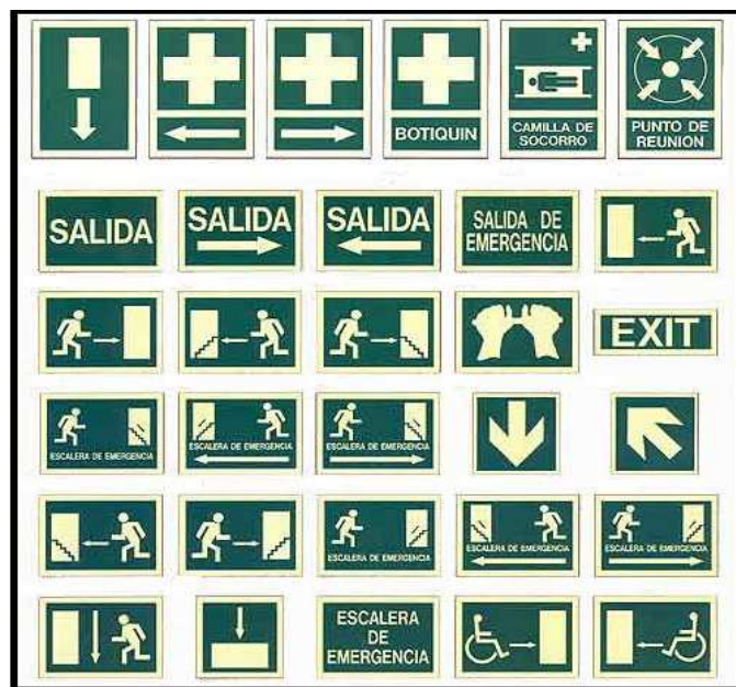
Figura 2.7 Señales de Salvamento
