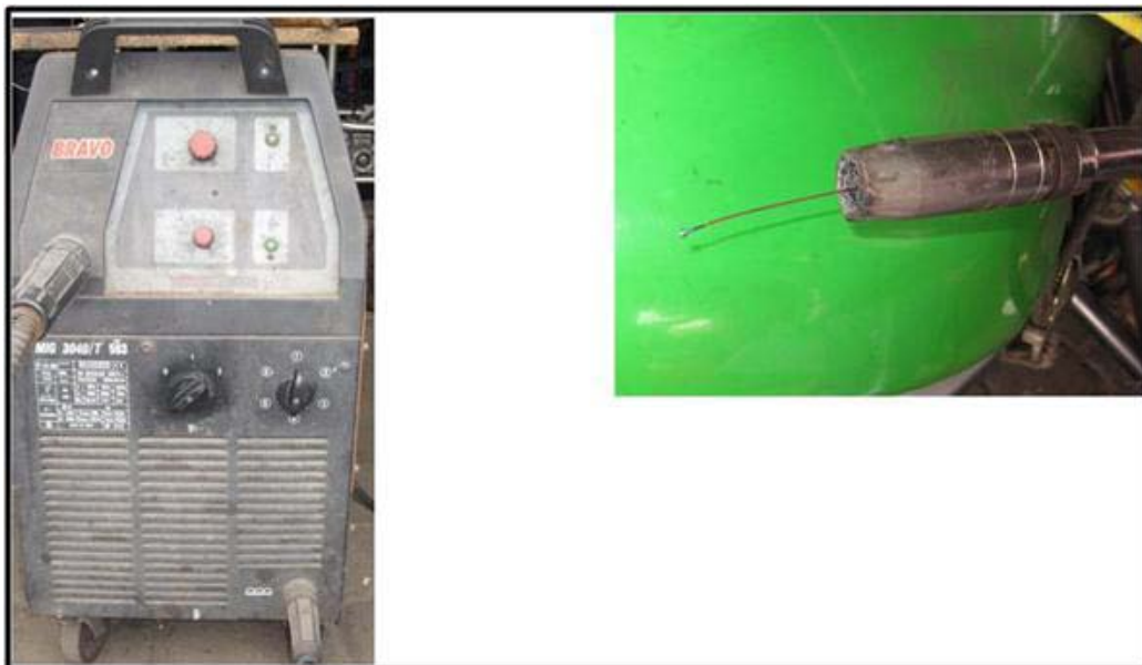
Figura 35: suelda MIG, boquilla e hilo de aporte
