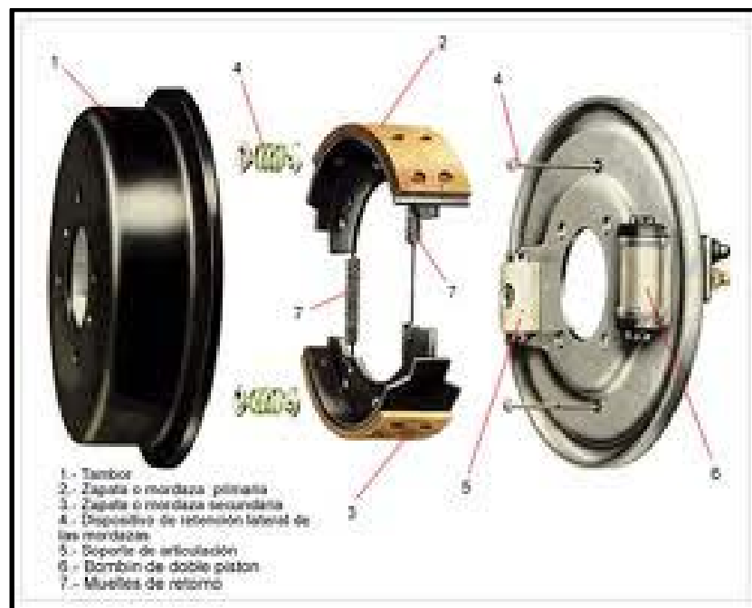
Figura 64: interior del tambor de freno
