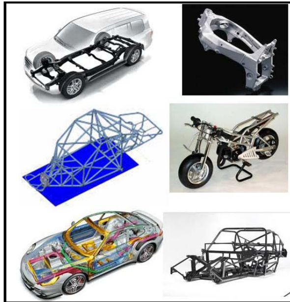
Figura 16: diferentes tipos de chasis
