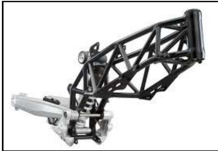
Figura 9: chasis tubular de moto
