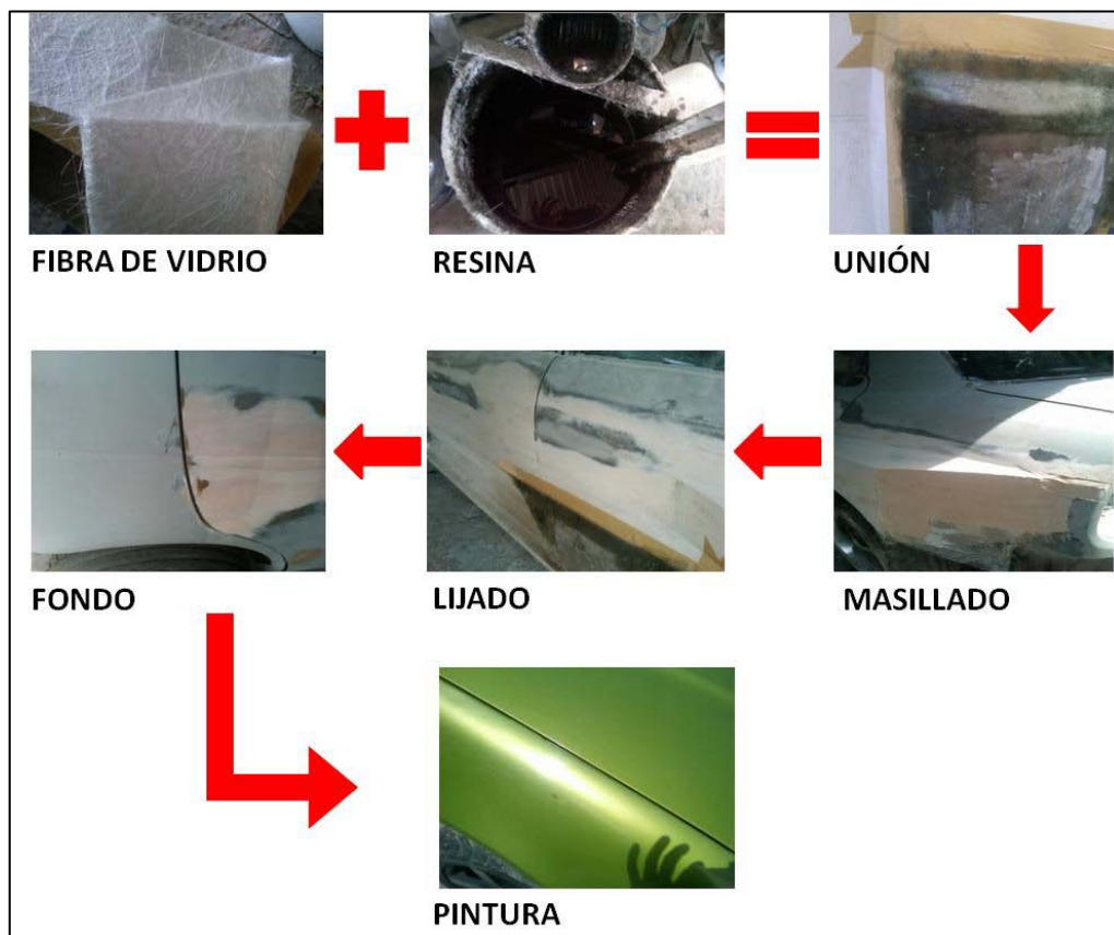
Figura 53: proceso de preparación de la fibra de vidrio
