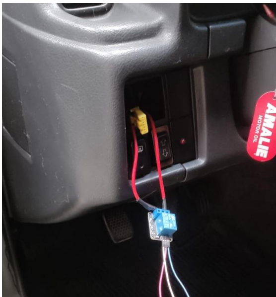
Instalación de relé de sistema DRL
