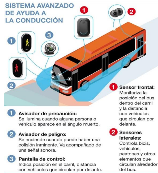
Imagen 21: Sistema ADAS- incorporado en Buses urbanos
