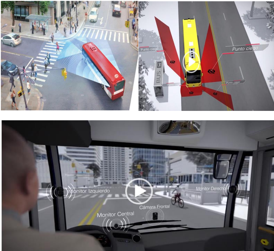
Imagen 20: Sistema ADAS- incorporado a los Buses
