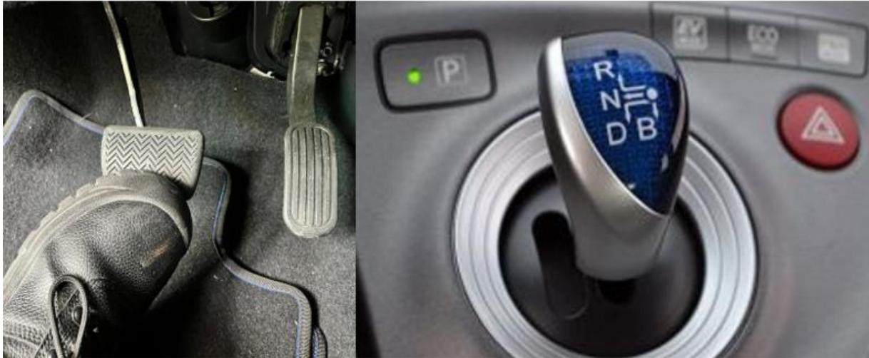
6. Pisar 2 veces el acelerador y se mostrará en el panel de instrumentos el siguiente mensaje "modo mantenimiento" o "maintenance mode", como se ve en la figura 45.
