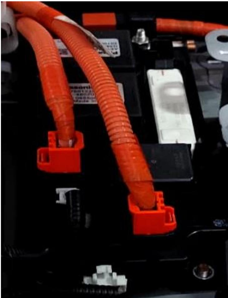
Este conjunto principal de los relés, tiene como objetivo realizar la conexión del sistema híbrido con los demás componentes, mediante la siguiente función SMR (System Main Relay) 2, siendo esta conexión directamente al positivo del vehículo, el SMR 3, su conexión será conectada al negativo o masa del mismo y por último SMR 1 servirá como protección del sistema, tal cual se muestra en la siguiente figura 61.
