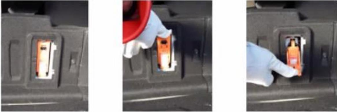
El jumper de seguridad cumple la función de dividir el voltaje, cuenta con un fusible principal (de 125 amp.) altamente resistente, además cuenta también con un switch de interbloqueo que al abrirse el mismo dejaría de ser leído por la ECU de la batería híbrida y no daría paso para encender el vehículo, por esto se realizó una comprobación como se observa en la figura 59.
