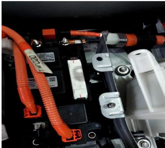
**Desarmado de la Carcasa de la batería HEV**
