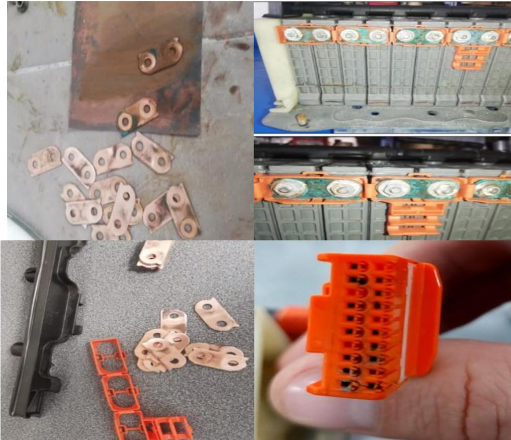
El procedimiento para realizar el mantenimiento de los bornes, se lo hace con una solución a base de agua, limón y bicarbonato con la finalidad de romper y cortar el sulfato en los bornes.
