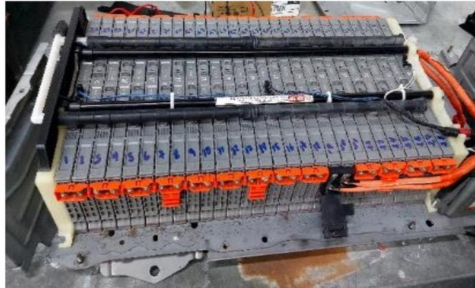
**Desmontar componentes de la batería HEV**
