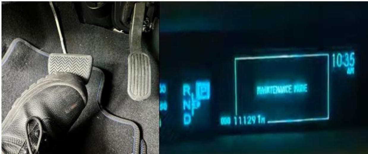
7. Pisar el freno y pulsar el botón Start y el motor a combustión interna (Ciclo Atkinson) se encenderá como se ve en la figura 46.
