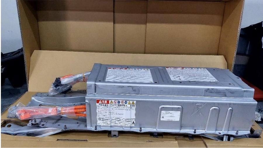
Como se puede ver en la imagen desde fábrica la batería HEV nueva viene solo con los cables, los módulos y carcasa, con la finalidad de usar el conjunto de reles, módulo controlador de tensión, ventilador, sensores de temperatura y demás accesorios.
